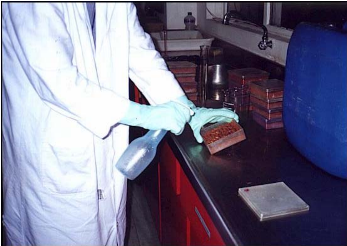
Figura C43 – Aspersão de lixiviado sobre sementes dispostas em argila.
