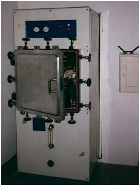
Figura C58 – Autoclave utilizada para a esterilização do lixiviado no experimento de inoculação.
