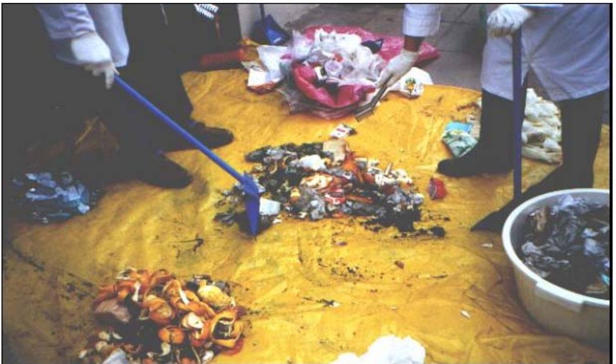
Figura C24 – Separação de RSSS recolhidos do bloco cirúrgico do HCPA. Material plástico ao fundo e matéria orgânica abaixo, à esquerda.
