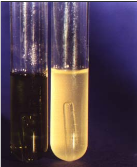
Figura C33 – Visualização da resposta do teste de verificação da presença de coliformes fecais e totais (observe-se detalhe da produção de gás).
