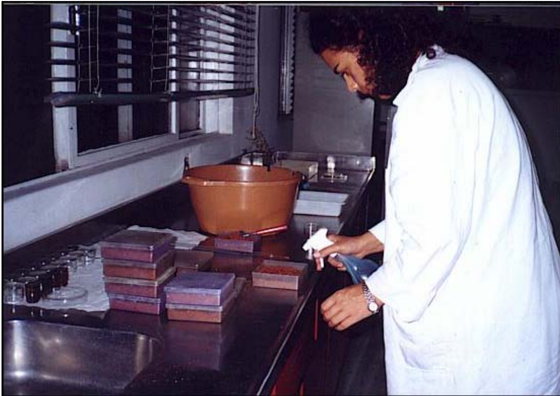
Figura C42 – Aspersão de água deionizada sobre sementes dispostas em argila.
