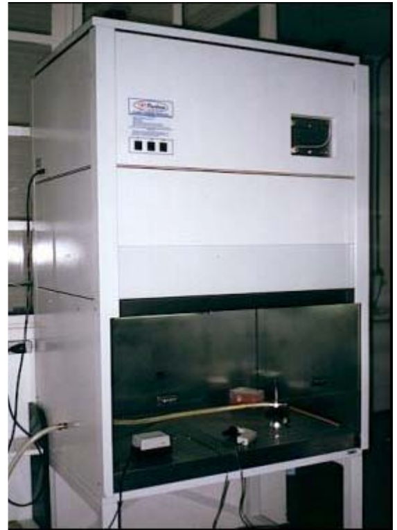
Figura C59 – Capela de fluxo laminar utilizada para a manipulação das amostras no experimento de inoculação.
