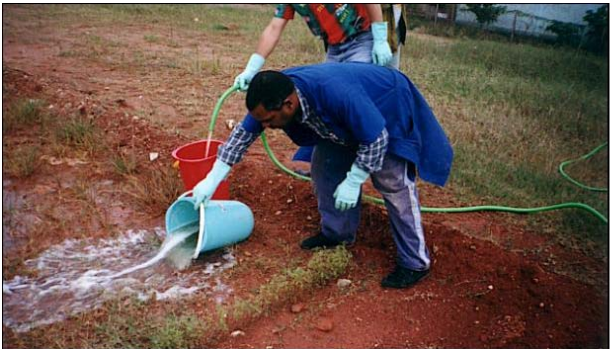
Figura C39 – Lixiviado sendo depositado sobre a superfície da célula C1.
