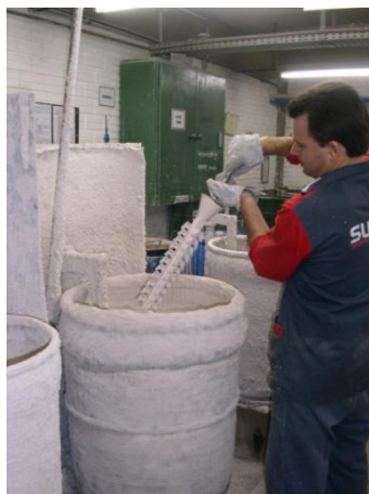
Figura 41 -Imagem do operador aplicando à primeira lama no tanque de lama de zirconita 19 .
