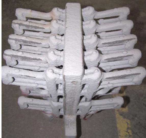
Figura 4-Molde do processo de fundição de precisão com último banho, pronto para deceragem 19 .
