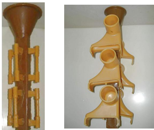
Figura 38-Imagens dos cachos do processo de fundição de precisão, (a), corpos de prova para ensaio de tração (b) peças do teste.
