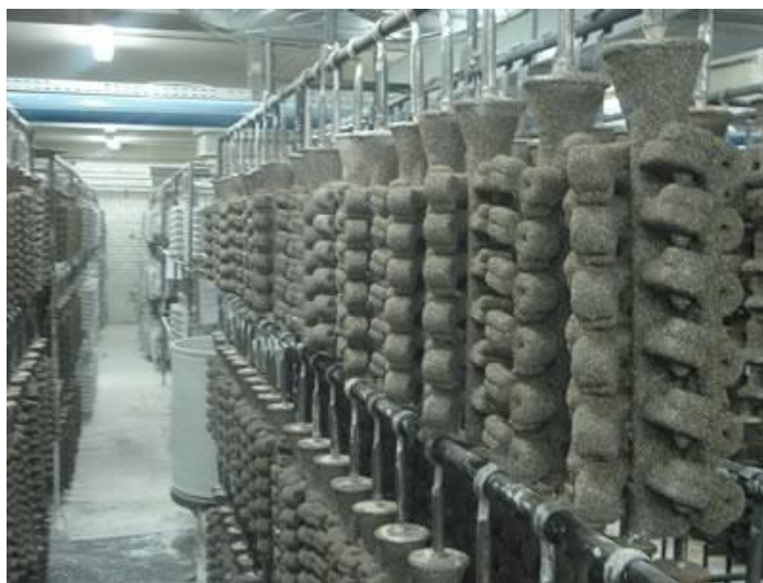
Figura 43-Fotografia dos cachos do processo de fundição de precisão após a 7ª camada de revestimento secundário 19 .
