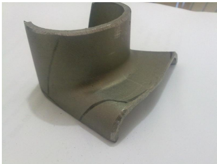
Figura 61-Fotografia da aresta entre o cilindro e a face frontal da peça com ausência de porosidades abertas na região crítica.
