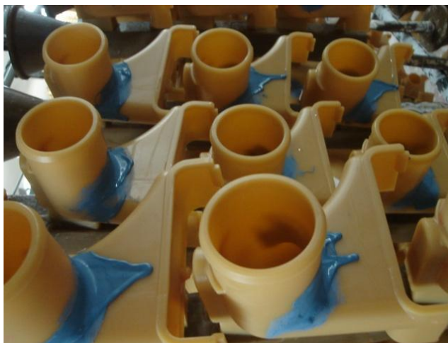
Figura 40-Peça com pintura de lama contendo aluminato de cobalto região de ocorrência do modo de falha porosidade.
