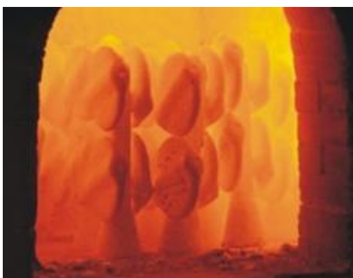
Figura 6- Molde cerâmico dentro do forno de calcinação à temperatura de 1050 °C durante o processo de calcinação 8 .
