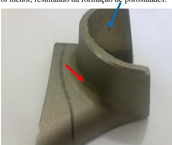
Figura 62-Fotografia da aresta da peça demonstrando a presença de porosidades abertas indicada pela seta em cor vermelha, a seta em cor azul indica manchas de secagem, oriundas do teste de estanqueidade.
