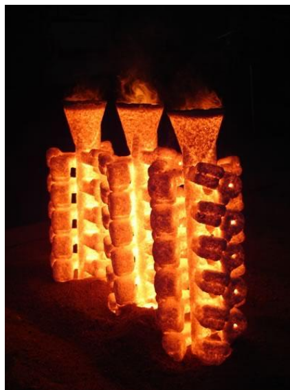
Figura 44-Fotografia dos cachos do processo de fundição de precisão após o vazamento do metal líquido 19 .
