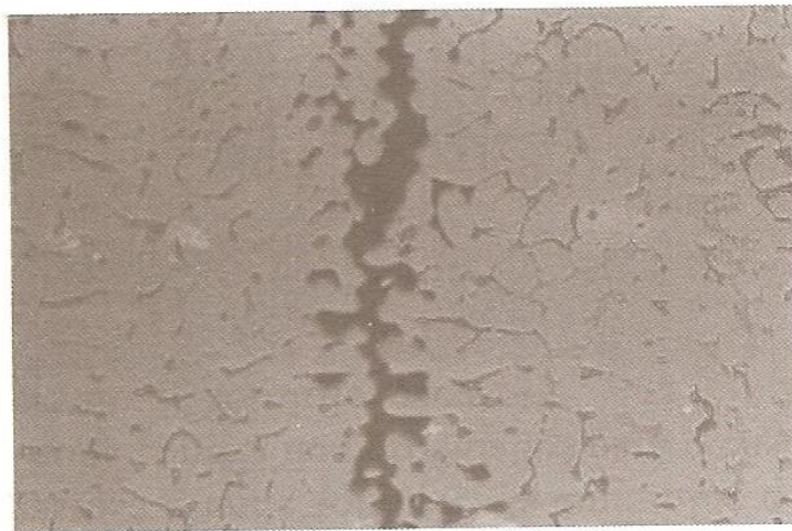
Figura 15-Micrografia de uma porosidade no interior de um componente fundido evidenciando a ausência de matéria numa região do componente 7 .
