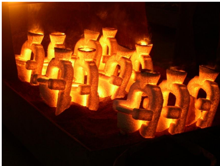
Figura 7 - Imagem de cachos de processo de fundição de precisão na caixa de areia após o processo de fundição 6 .
