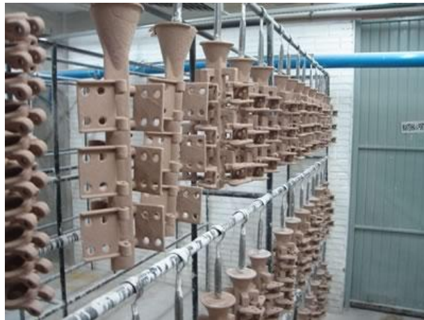
Figura 42-Fotografia dos cachos durante a secagem após o processo de revestimento primário 19 .
