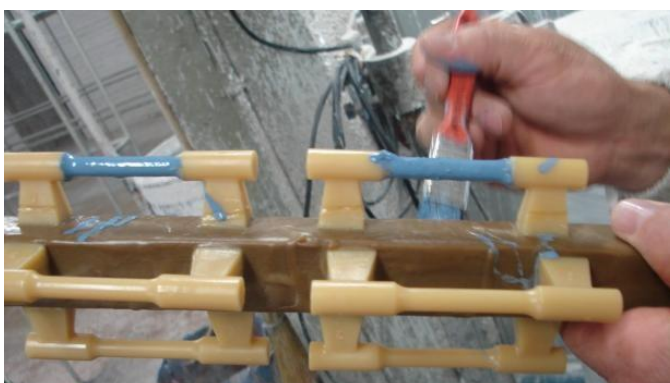
Figura 39 - Imagem do processo de pintura dos corpos de prova para o ensaio de tração com lama contendo aluminato de cobalto.
