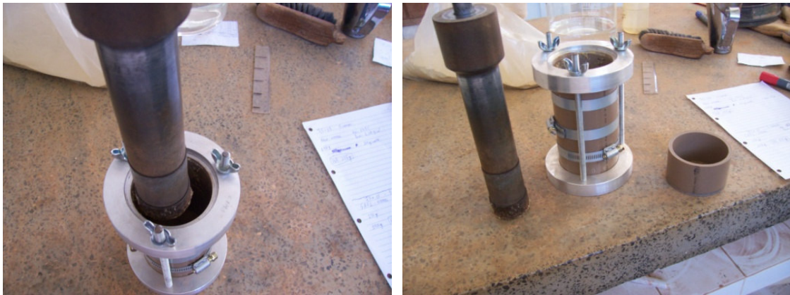
Figura 3.30 Detalhes da compactação do corpo-de-prova de 7,5 x 15 cm
