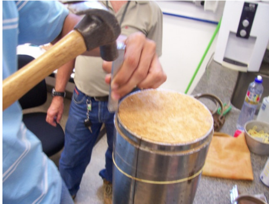
Figura 3.42 Desmoldagem de corpo-de-prova de 15 x 30 cm
