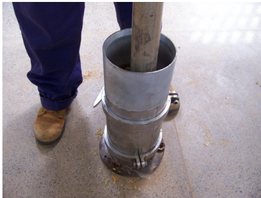
Figura 3.36 Compactação da última ou penúltima camada devido ao uso do colarinho
