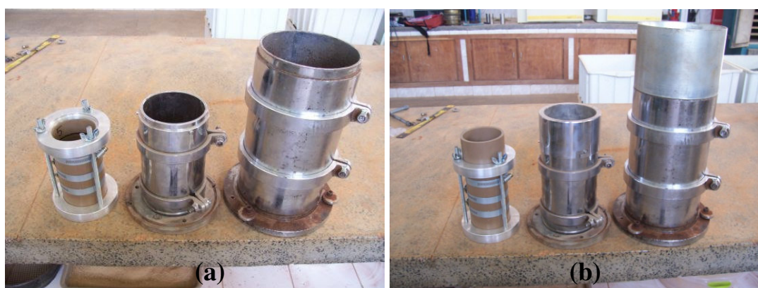
Figura 3.27 Em (a) moldes dos 3 tamanhos de corpo-de-prova e em (b) com seus respectivos colarinhos
