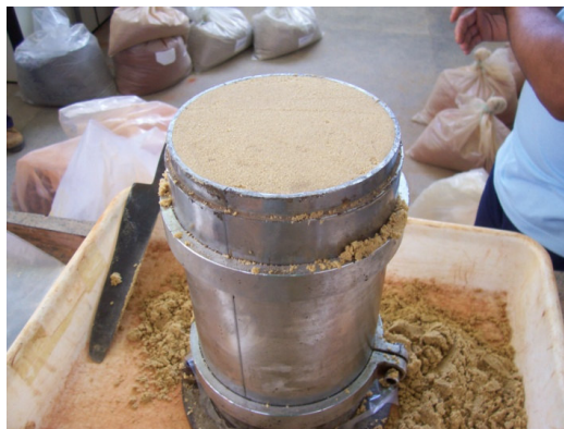
Figura 3.38 Razagem do corpo-de-prova
