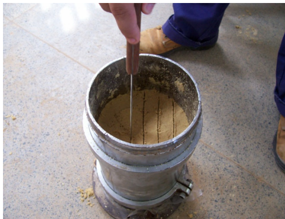
Figura 3.37 Escarificação entre as camadas
