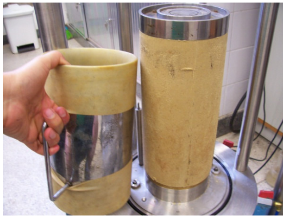
Figura 3.43 Corpo-de-prova de 15 x 30 cm de areia a ser envolto por membrana
