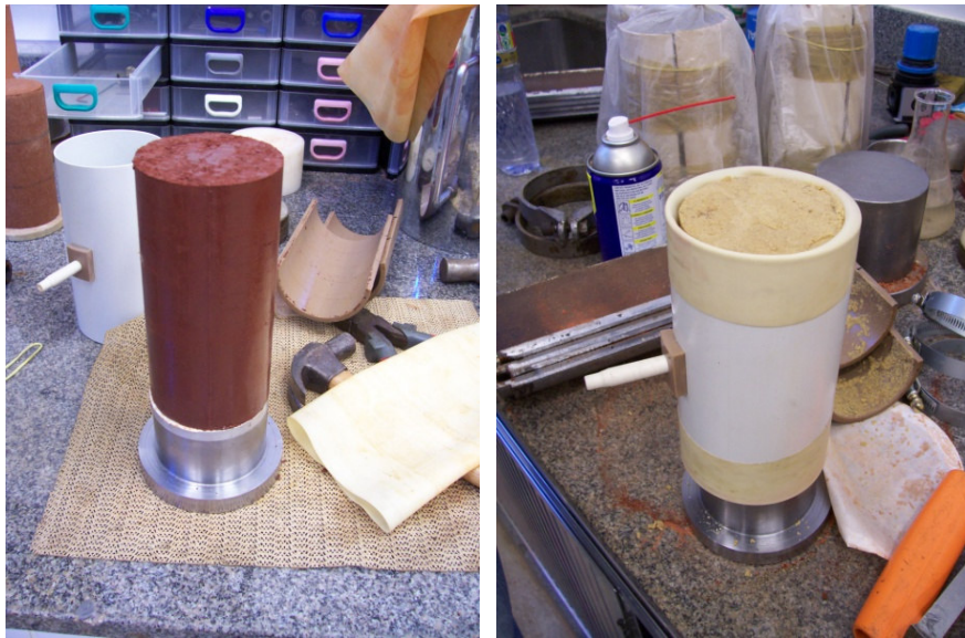
Figura 3.31 Desmoldagem e colocação da membrana no corpo-de-prova de 7,5 x 15 cm
