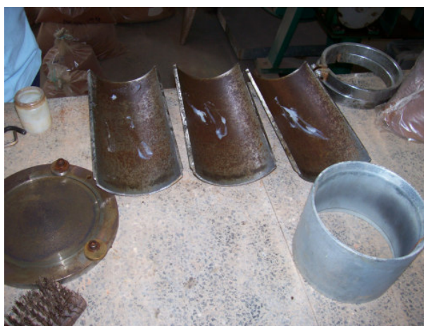
Figura 3.26 Molde tri-partido para compactação de corpo-de-prova de 15 x 30 cm
