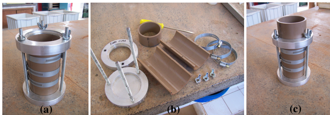
Figura 3.28 Molde 7,5 x 15 cm: em (a) montado, em (b) desmontado e em (c) com o colarinho
