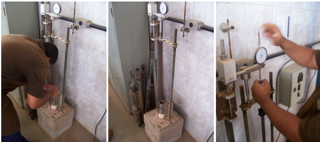
Figura 3.20 Imagens do ensaio Mini-MCV durante a compactação
