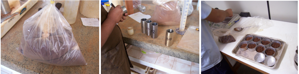
Figura 3.19 Imagens do ensaio Mini-MCV durante a preparação das amostras
