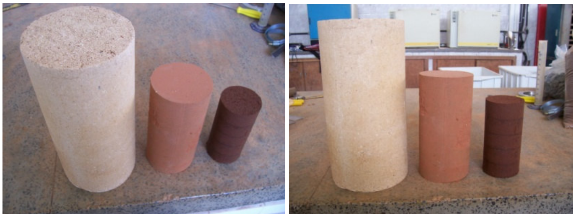
Figura 3.46 Corpos-de-prova de 7,5 x 15, 10 x 20 e 15 x 30 cm de solos desta pesquisa.
