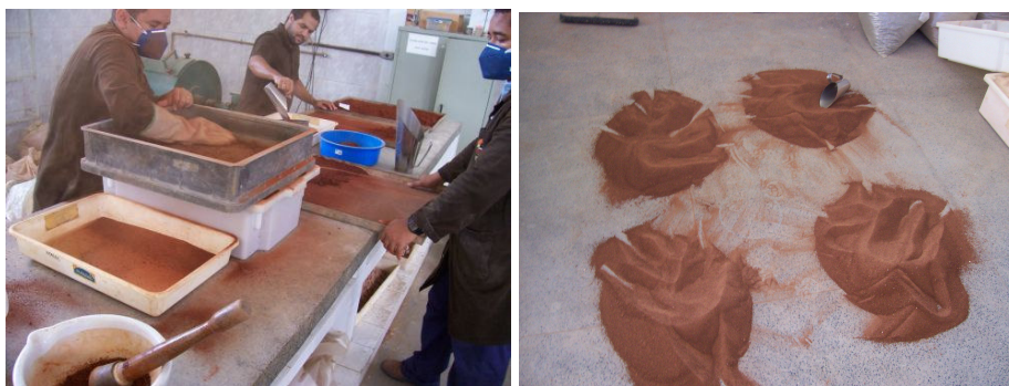
Figura 3.18 Amostras sendo preparadas no laboratório da COPPE/UFRJ para ensaio MCT
