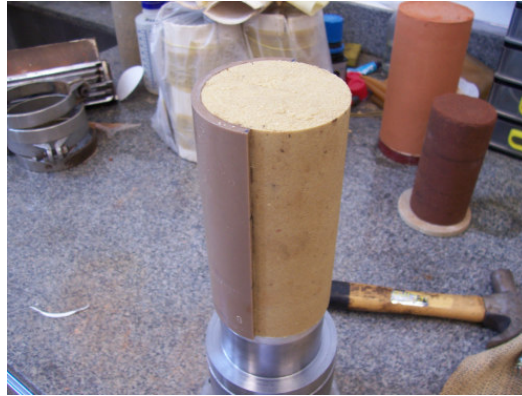
Figura 3.29 Corpo-de-prova de 7,5 x 15 cm sendo desmoldado para o ensaio
