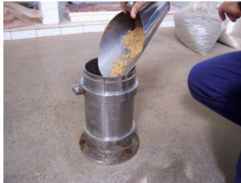
Figura 3.34 Colocação de material para a compactação de uma camada em corpo-de-prova de 15 x 30 cm
