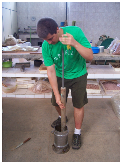
Figura 3.35 Compactação de corpo-de-prova de 15 x 30 cm
