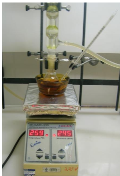
Figura 4 – Foto da reação de polimerização de metil-ésteres epoxidados (MEE) em presença de anidrido ftálico (AF) e 2-metil-imidazol (2MI).
