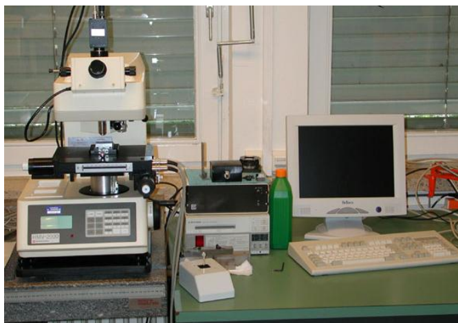
Figura 20 – Microdurômetro SHIMADZU-HMV-2000 utilizado para obtenção dos perfis de dureza da junta soldada.
