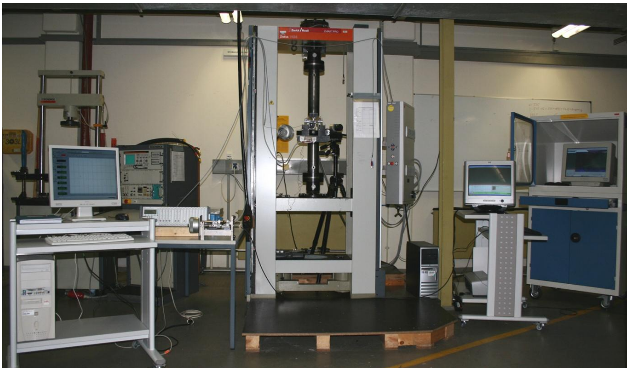
Figura 25 – Visão geral do ensaio de tenacidade à fratura monitorado com SOMD.
