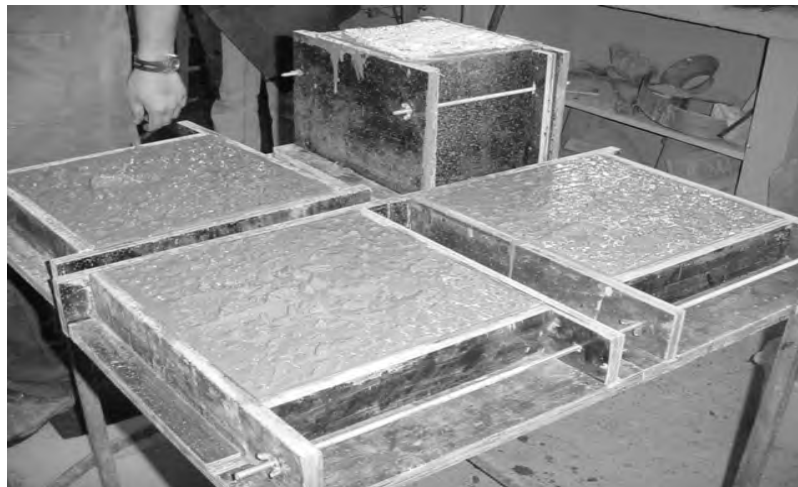
Figura 5.6 - Corpos-de-prova em forma de placa para ensaio de impacto.
