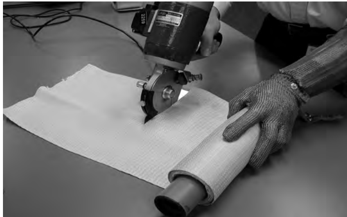
Figura 4.8 – Corte do tecido de aramida com disco de corte.
