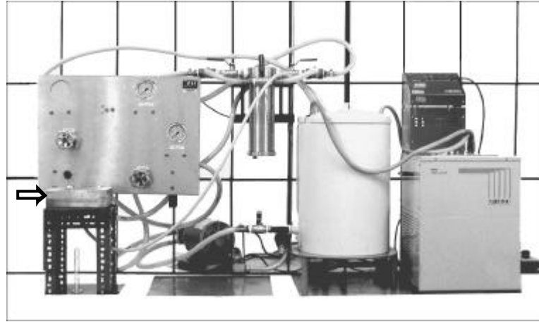
Figura 3.2: Fotografia do equipamento do sistema de OR, com módulo para membrana plana.
