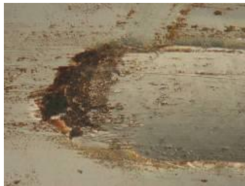
Figura 67 – Amostra de AISI 316L testada por tribocorrosão sob polarização potencioestática de -0,7V.
