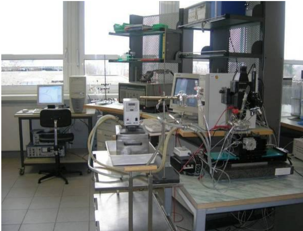
Figura 20 - Sistema de medidas de Tribocorrosão formado por dois computadores para controle do Potenciostato/Galvanostato PAR 273 A e do tribômetro IPA TRIBOTEST, dois softwares para análise de corrosão, tribologia e imagem (micrografia digital), transdutor de sinal mecânico/elétrico, célula eletroquímica de três eletrodos, microscópio ótico e câmara digital acoplados a célula, sistema de circulação de água para controle de temperatura da célula.
