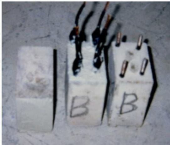
Figura 5.8 Conexão de fios nas barras e isolamento do fundo e do topo com epóxi.
