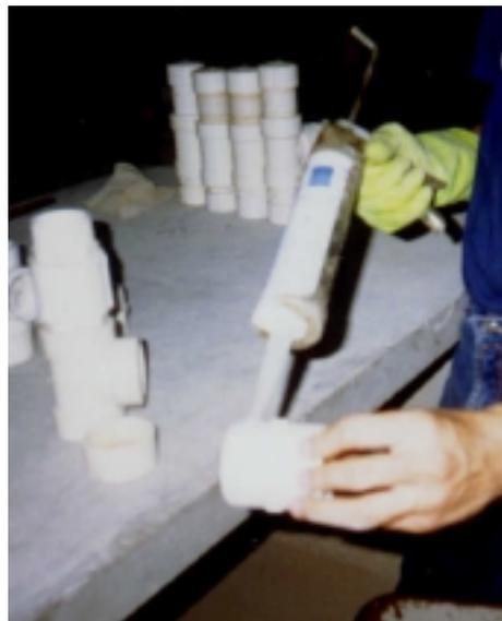
Figura 5.16 Vedação da câmara positiva com silicone.
