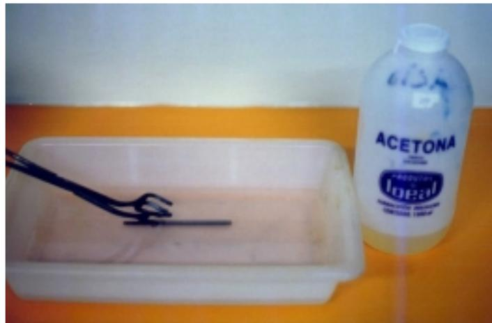
Figura A.4 Imersão das barras em acetona para eliminação da água
