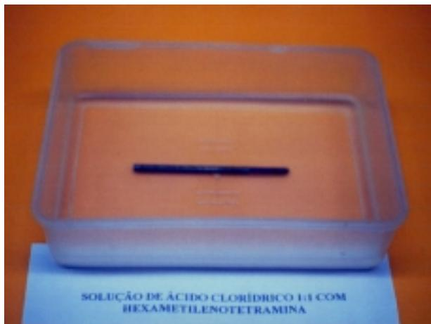
Figura A.1 Imersão das barras em solução de ácido clorídrico 1:1 com 3,5% de hexametenotetramina para remoção dos óxidos
