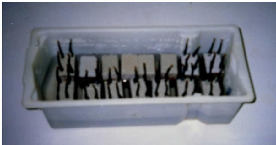
Figura 5.12 Umedecimento dos CP's do ensaio de corrosão através de imersão parcial (até a metade das barras) em solução com 3,5% de NaCl por 02 dias (cada semi-ciclo).
