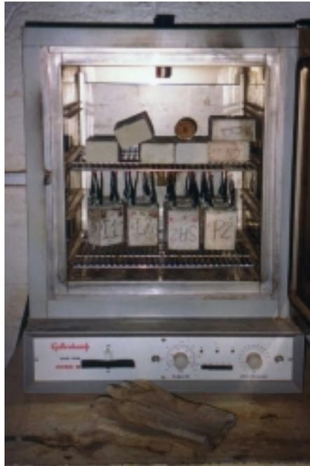
Figura 5.11 Secagem dos CP's do ensaio de corrosão em estufa a 50 °C durante 05 dias (cada semi-ciclo).
