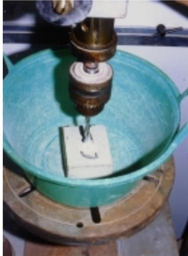
Figura 5.18 Coleta de amostra dos corpos-de-prova para determinação do teor de cloretos.
