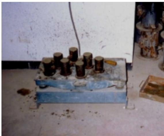
Figura 5.13 Adensamento dos corpos-de-prova dos ensaios complementares.
