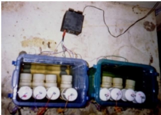
Figura 5.17 Células de difusão formadas por quatro câmaras positivas e uma câmara negativa
