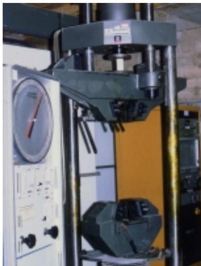
Figura 5.19 Prensa hidráulica da marca Amsler.
