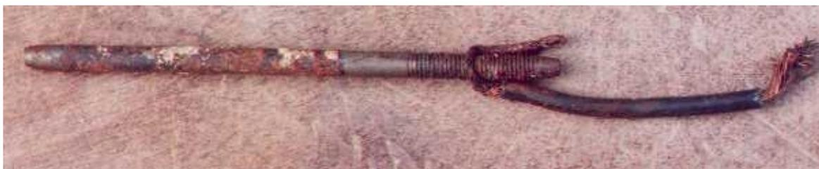
Figura 6.40 Corrosão na barra sob a fita
