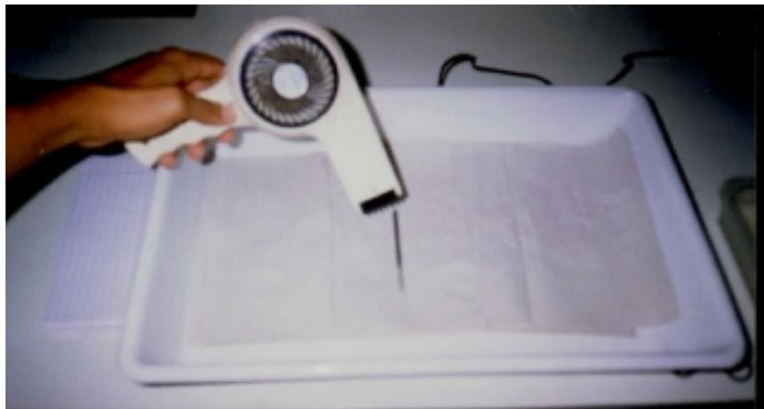
Figura A.5 Secagem das barras com jato de ar quente
