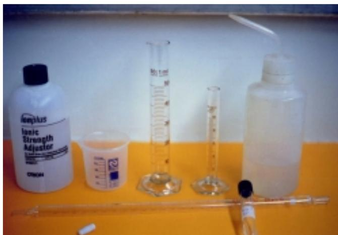
Figura C.1 Materiais utilizados na preparação da solução com cloretos para determinação da concentração dos mesmos, através do eletrodo de íon seletivo
