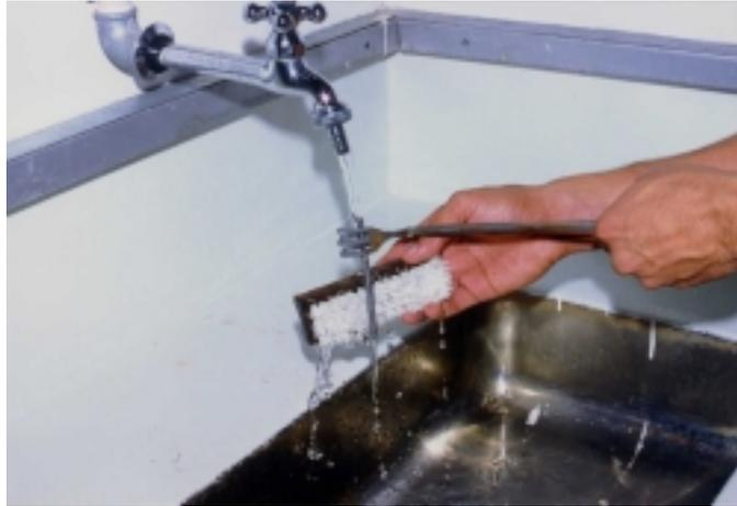
Figura A.3 Escovação das barras para a remoção final dos óxidos
