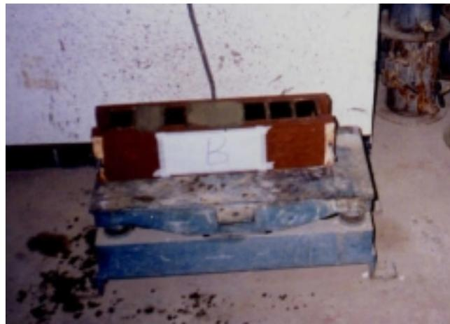
Figura 5.7 Adensamento dos corpos-de-prova prismáticos utilizando-se a mesa vibratória.
