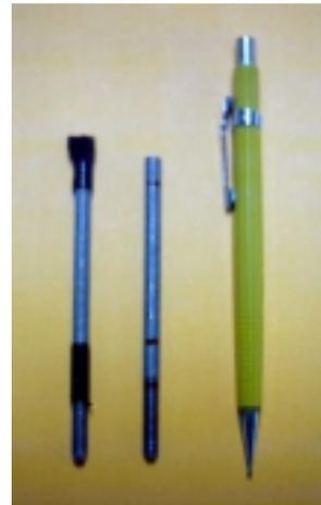
Figura 5.4 Isolamento da área das barras que não sofreram corrosão.
