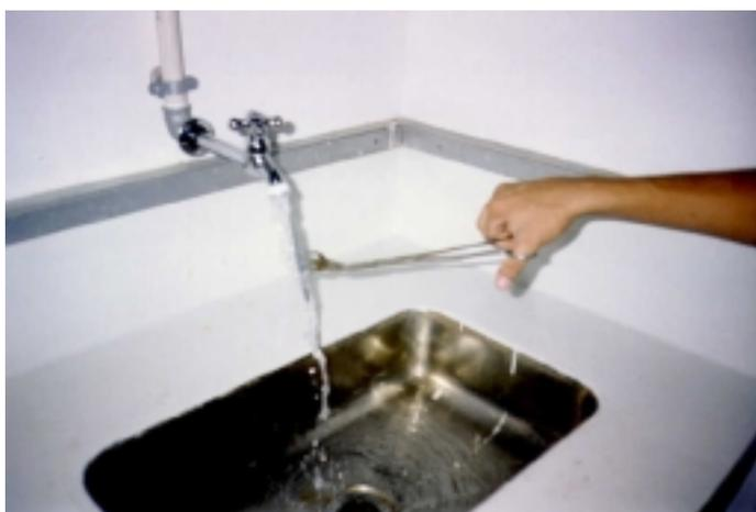
Figura A.2 Lavagem das barras em água corrente para remoção da solução
