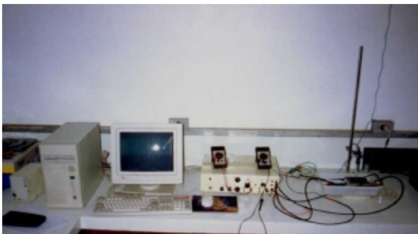
Figura 5.9 Potenciostato utilizado para se obter  $E_{\text{corr}}$ ,  $R_{\text{ohm}}$  e  $i_{\text{corr}}$ .
