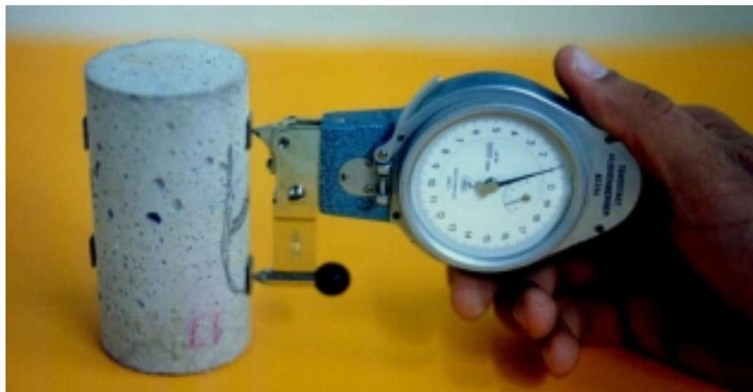
Figura 5.20 Leitura das deformações dos corpos-de-prova, através de extensômetros mecânicos.
