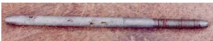
Figura 6.41 Barra de aço com corrosão por pites
