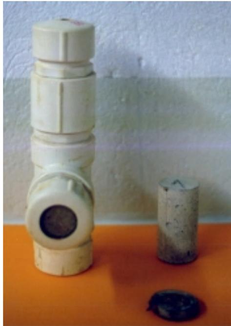
Figura 5.15 Câmara positiva utilizada no ensaio.
