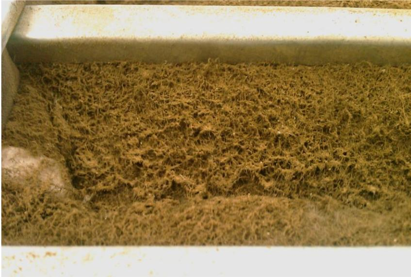
Figura 16 - Malha filtrante saturada após 4 meses de instalação.
