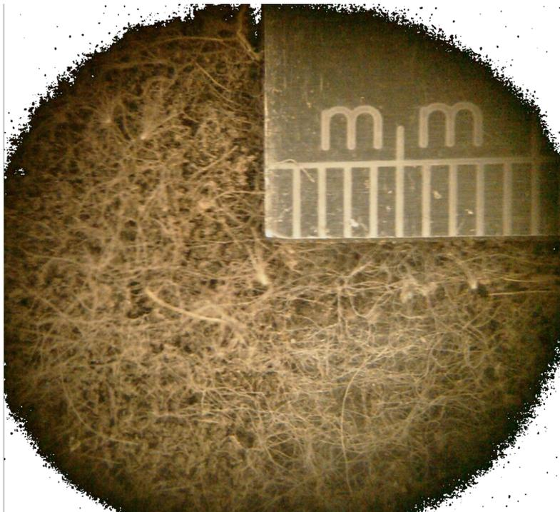
Figura 17 - Fibras da malha filtrante, partículas com tamanhos inferiores a 0,3mm
