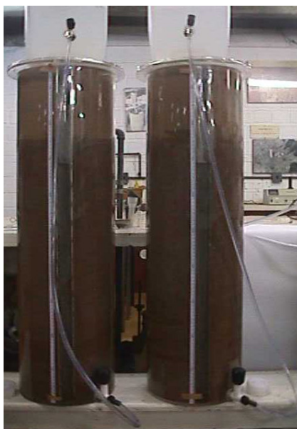
Figura 5.2. Foto do par de colunas com o reservatório de PVC usado na embebição
