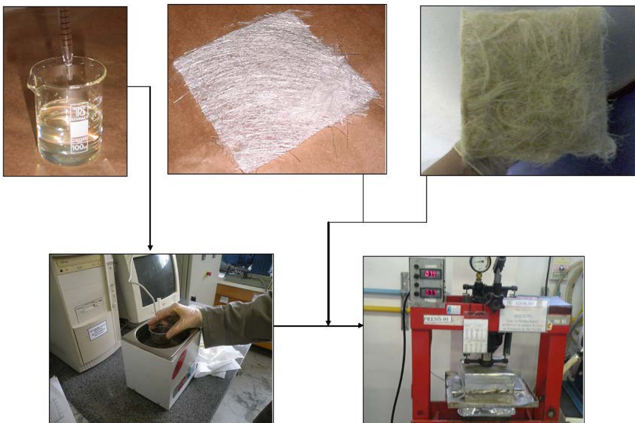
Figura 10 - Fluxograma de produção dos compósitos.
