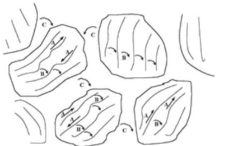
Figura 7 - Possíveis saltos dos portadores de carga onde A indica o transporte dentro da molécula, B o transporte entre as cadeias e C o transporte entre as partículas [16, 22].
