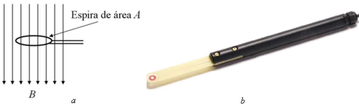
Figura 3-11. (a) Fluxo magnético através de uma área A (b) Bobina de campo comercial Magnet-Physik.
