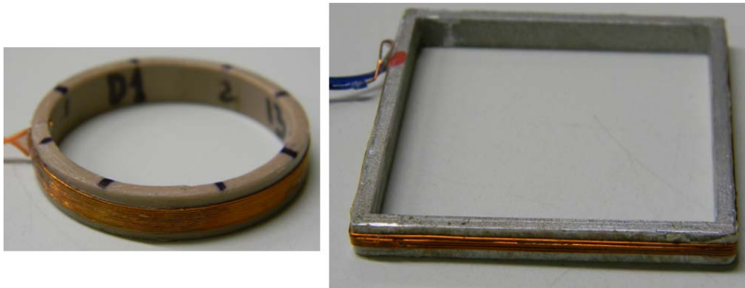
Figura 4-11. Bobinas fluximétricas para as diferentes geometrias.
