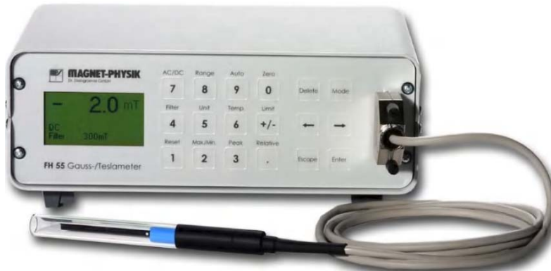
Figura 3-15. Gaussímetro de Efeito Hall com sonda Hall transversa comercial Magnet-Physik.
