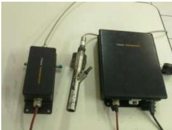
Figura 5.5 Pirômetro infravermelho móvel usado para medir a temperatura da superfície do lingote.
