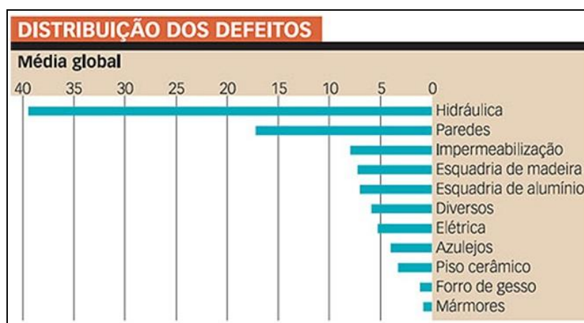
Figura 4: distribuição % dos defeitos encontrados nos edifícios analisados (BLANCO, 2007, p. 29)
