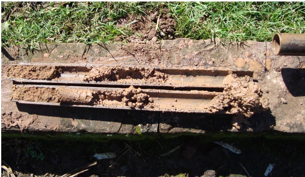
Figura 35: testemunho de sondagem
