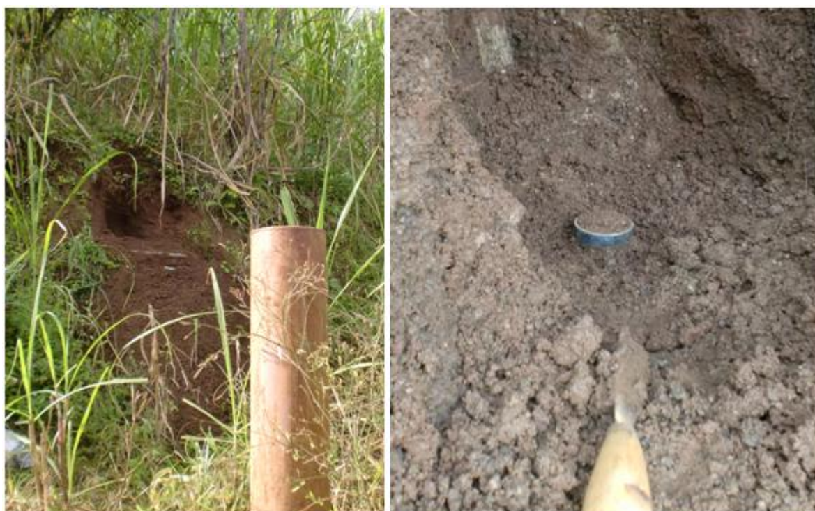
Figura 26: local e procedimento da coleta de amostras indeformadas
