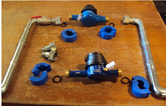
Figura 14: kit para instalação de hidrômetro utilizado pelo Departamento Municipal de Água e Esgotos.
