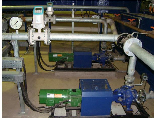
Figura 31: conjunto motor-bomba e medidor eletromagnético de referência
