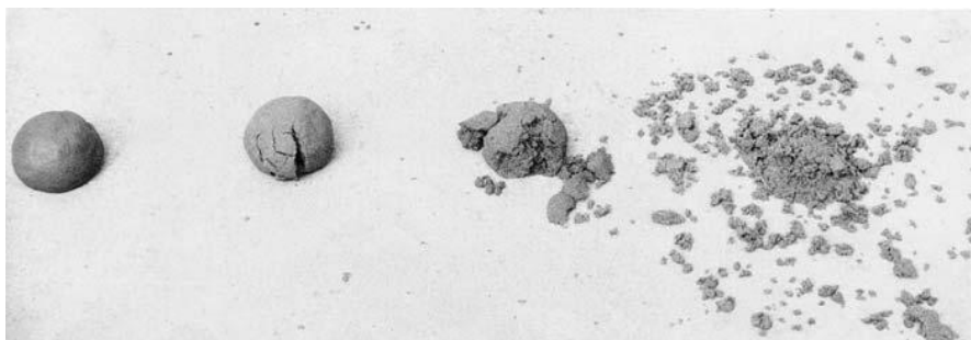
Figura 26: teste da bola caindo (MINKE, 2001, p. 23)
