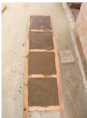
Figura 27: teste retração da argamassa 18
