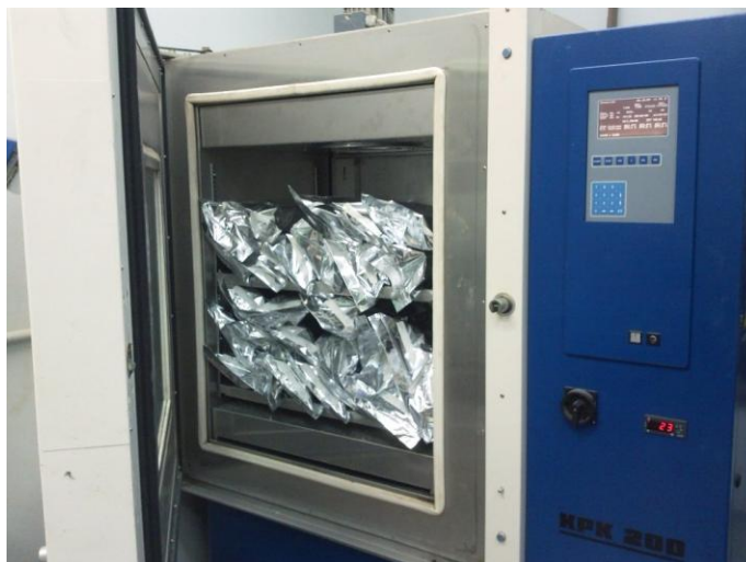
Figura 24: CP armazenados na câmara climatizada
