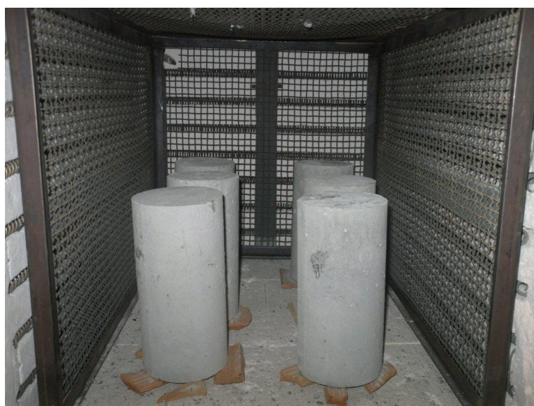
Figura 26: CP dentro do forno sobre pequenos pedaços de tijolo
