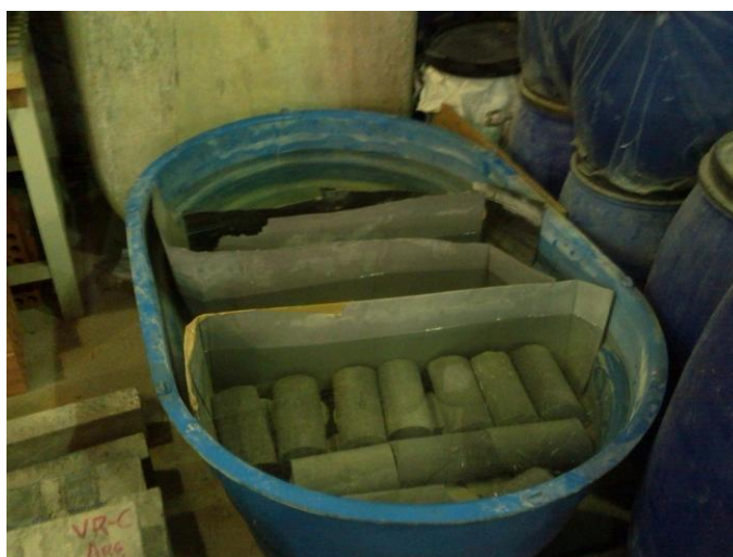
Figura 19: cura dos CP no reservatório
