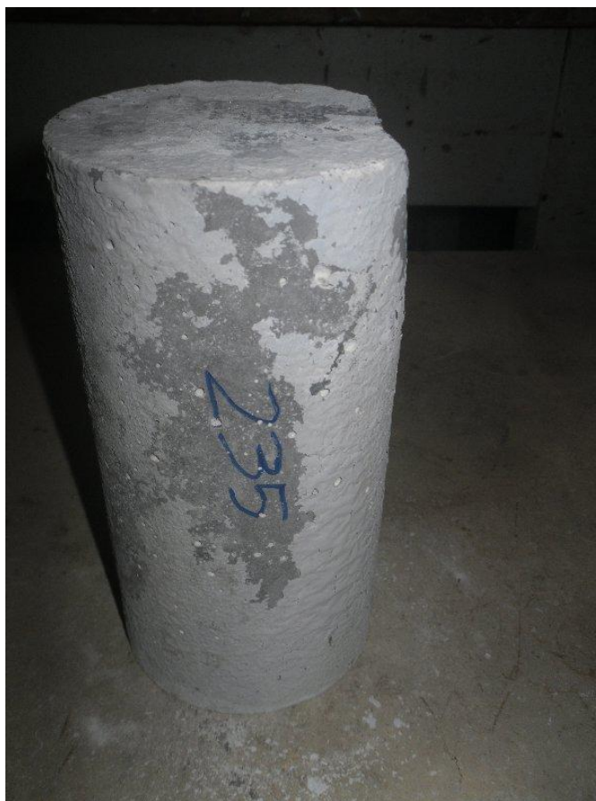
Figura 57: foto de um CP com alteração da superfície decorrente do aquecimento
