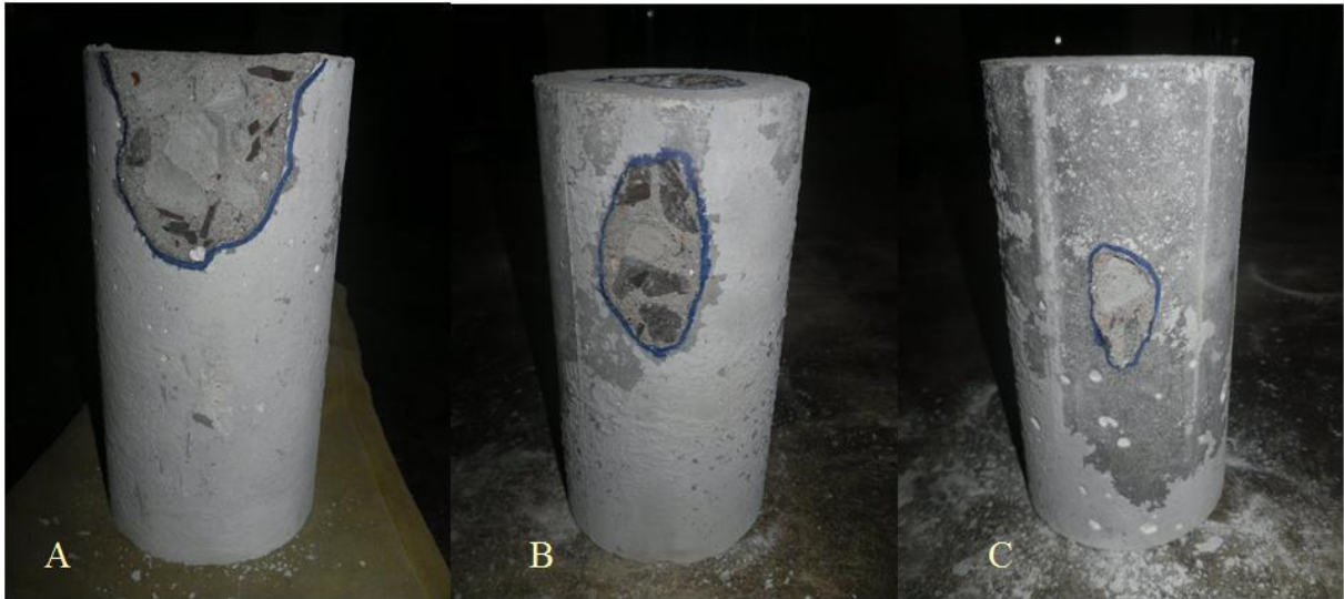
Figura 37: volumes de concreto deslocados avaliados como grande [A], médio [B] e pequeno [C]
