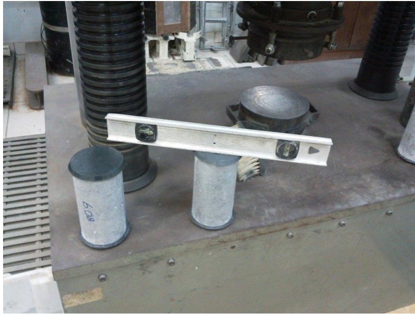
Figura 32: verificação da horizontalidade do capeamento
