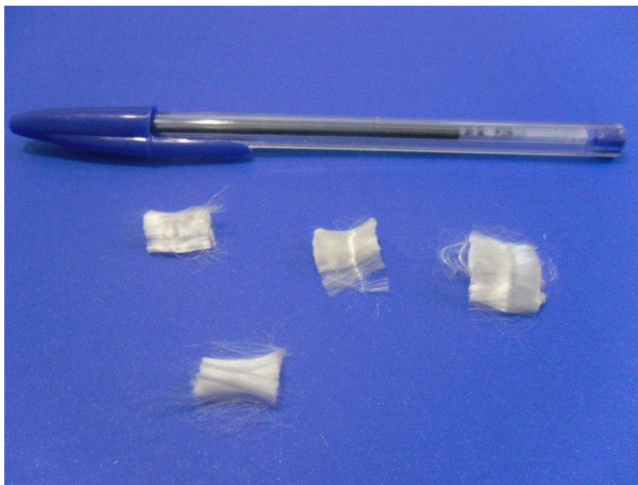
Figura 17: feixes de fibras de polipropileno ao lado de uma caneta da marca BIC
