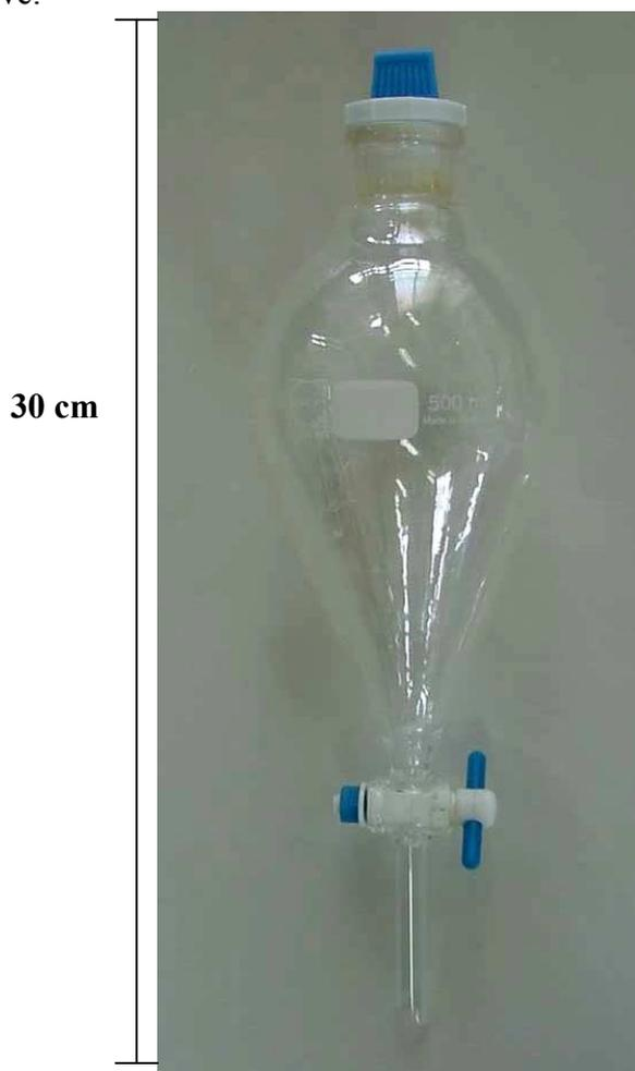
*Fig. 16 – Funil usado para Separação por Densidade.*
