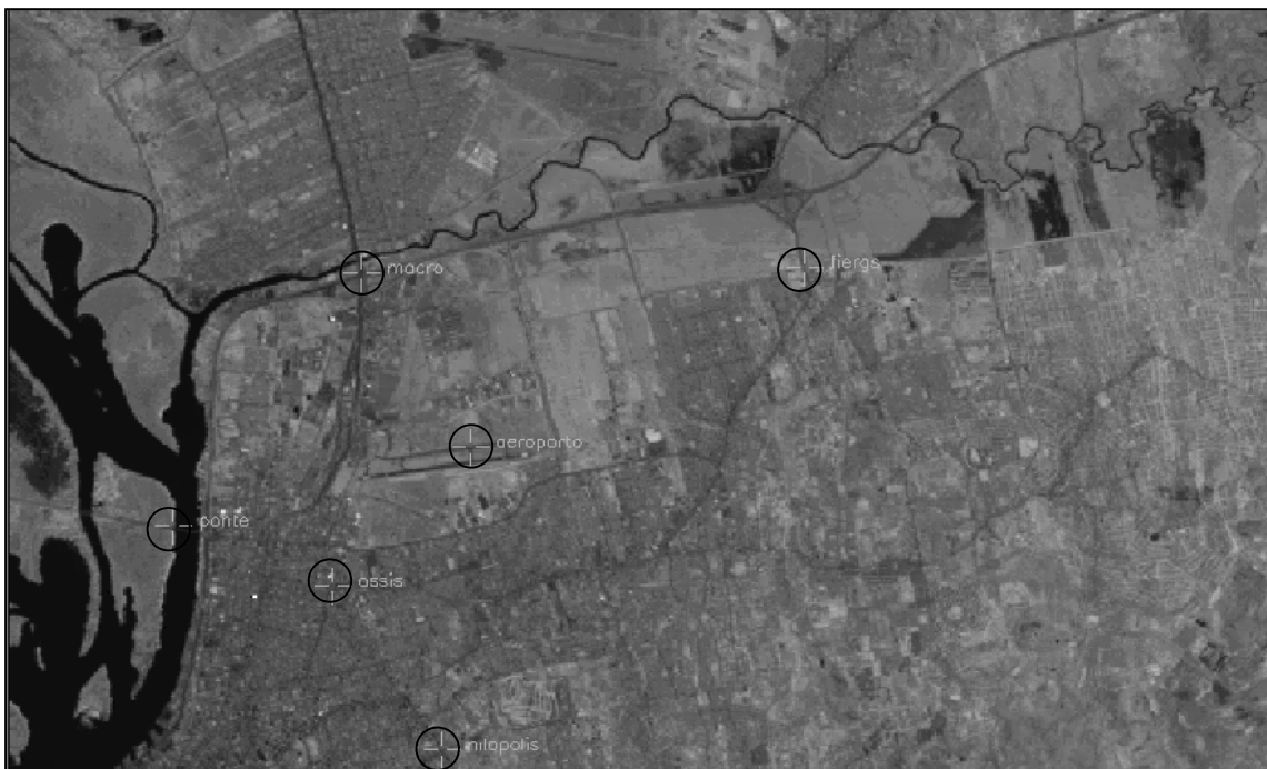
Figura 3.4: Imagem com cores falsas (RGB) sendo registrada no sistema de coordenadas desejado, onde seis são os pontos de controle distribuídos dentro da área de estudo.
