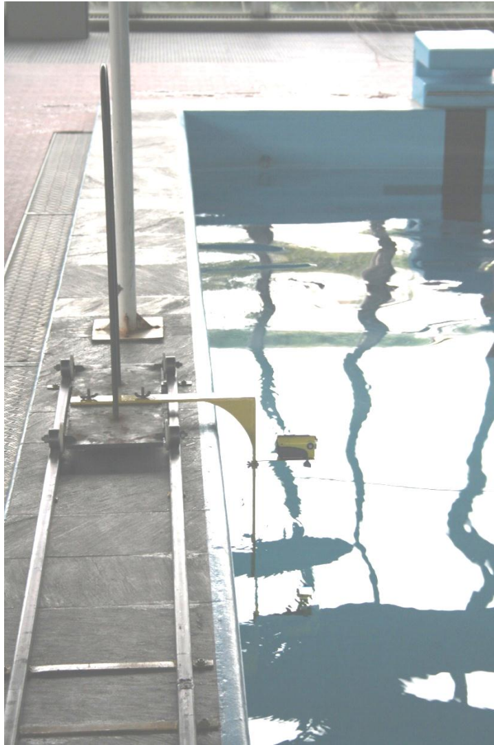
Figura 2 – Carrinho, trilhos e suporte para deslocamento das filmadoras ao longo da borda lateral da piscina, o que possibilitou a captura das imagens dos nadadores no estudo.
