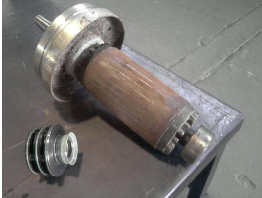
Figura 35 Eixo rotor com rolamentos, alojamento do rolamento e selo mecânico tipo cartucho.
