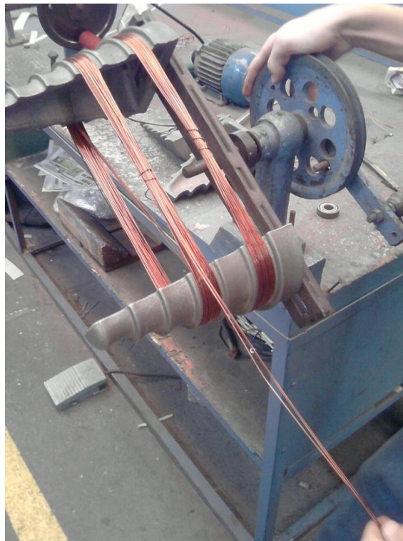
Figura 29 Máquina para enrolamento dos condutores das bobinas.
