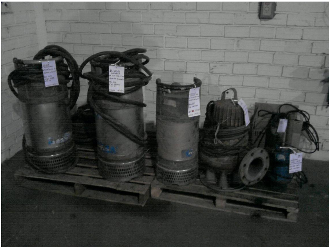
Figura 1 Típicas motobombas submersíveis reparadas.
