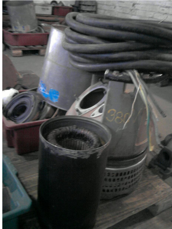
Figura 27 Motobomba submersível desmontada.
