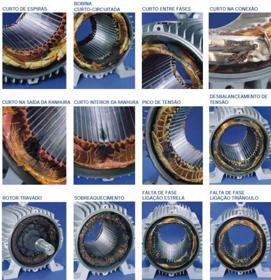
Figura 25 Exemplos de danos em motores trifásicos de indução WEG
