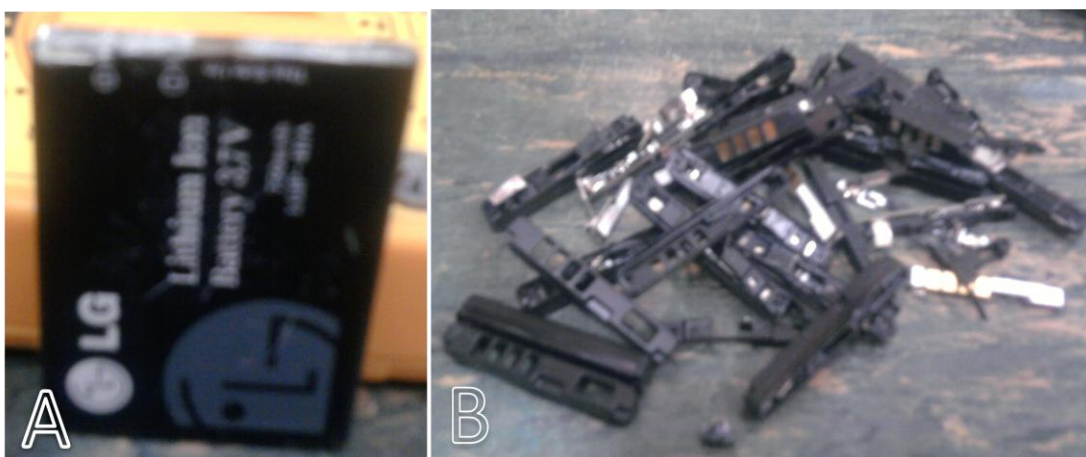
Figura-12 a) Bateria sem os terminais, b) terminais retirado das baterias.
