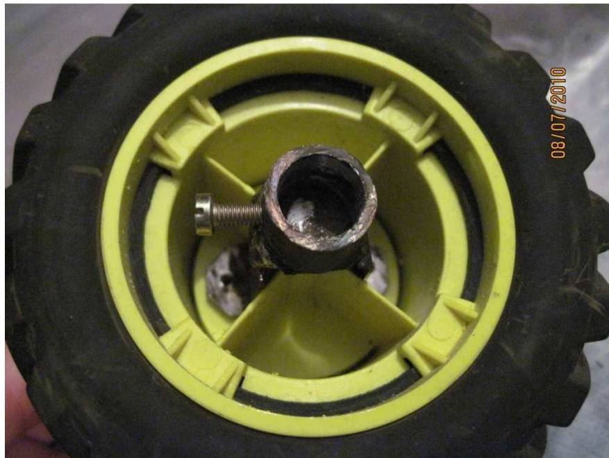
Figura A-2 Montagem do adaptador na roda
