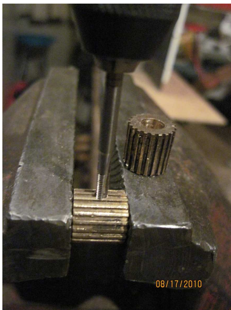
Figura A-12 Aproveitamento da engrenagem do motor de passo no eixo da caixa
