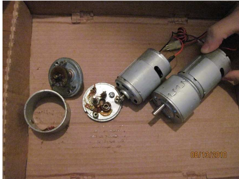
Figura A-9 motor com caixa de redução desmontado
