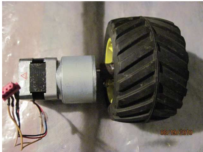
Figura A-16 Motor de passo com redução montado à roda
