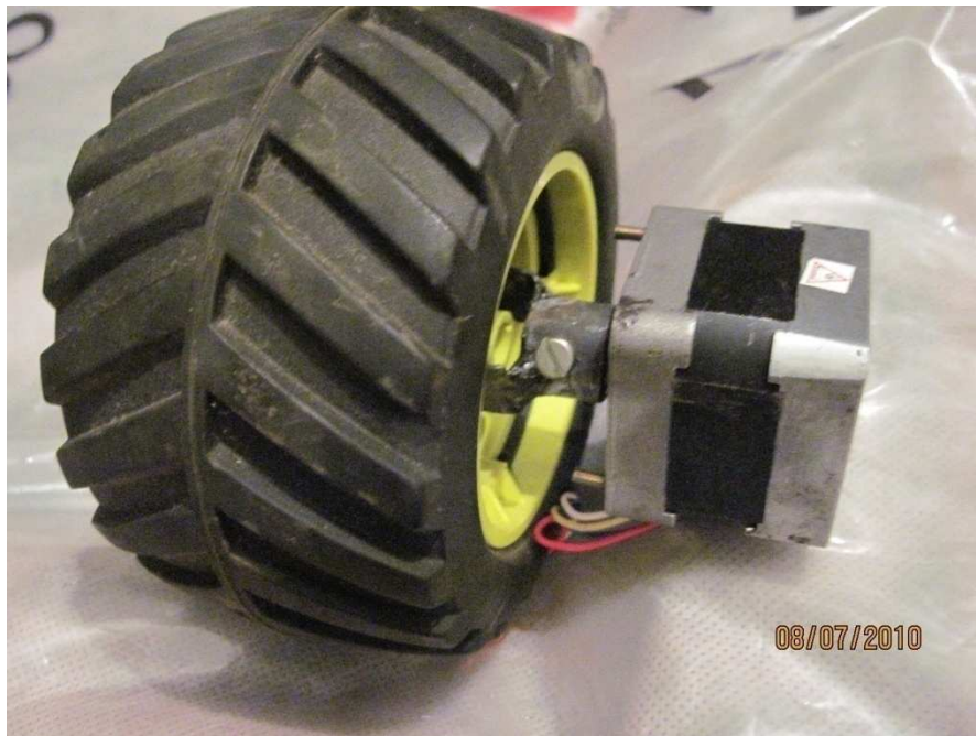
Figura A-4 Sistema roda, adaptador e motor fixado
