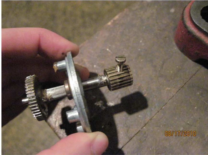
Figura A-13 Fixação da engrenagem no eixo da caixa de redução
