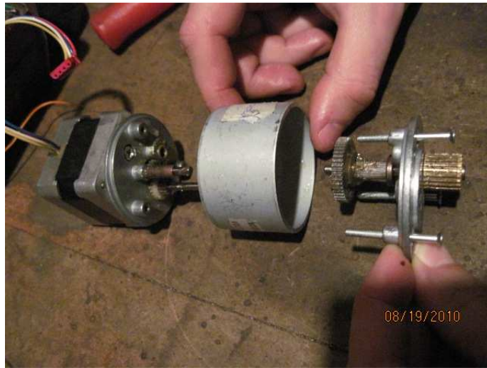
Figura A-14 Peças do sistema de motor de passo com redução
