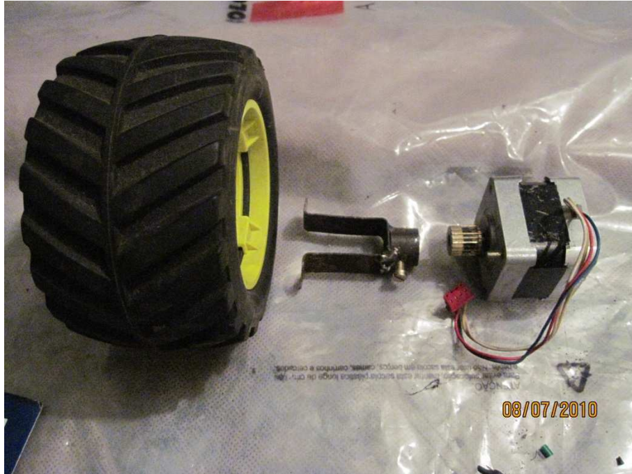
Figura A-1 Roda, adaptador e motor utilizados
