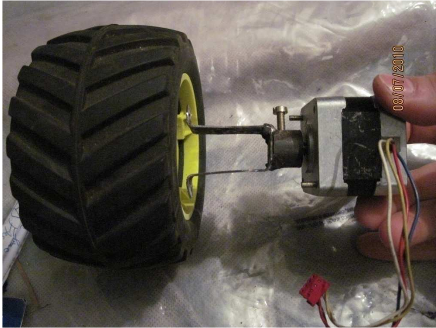
Figura A-3 Montagem do adaptador no motor e na roda
