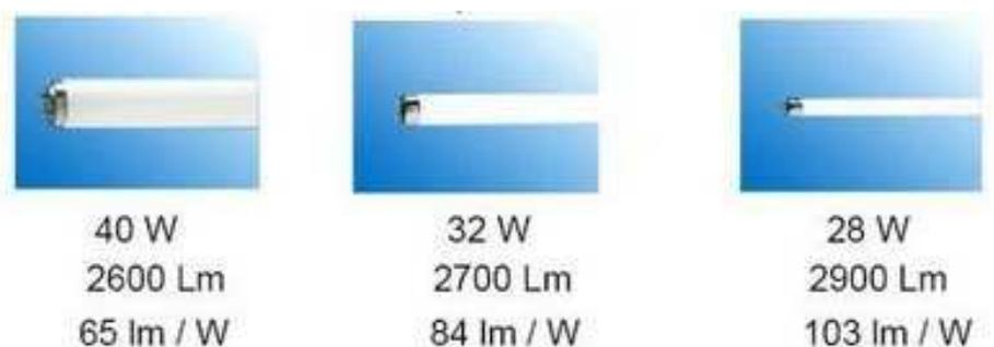
**FIGURA 45 – Comparação entre as lâmpadas.**
