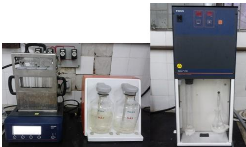
Figura 7. Sistema de digestão com lavagem de gases e destilador Kjeltec.
