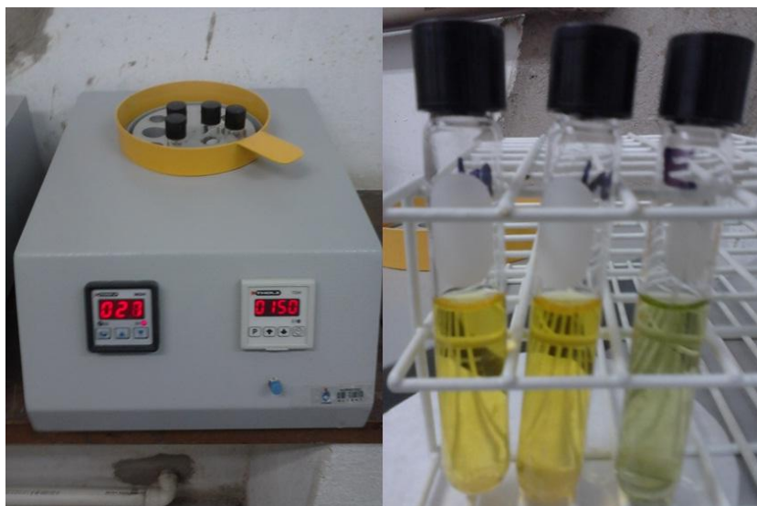
Figura 6. Digestor para DQO e tubos após digestão com K_2Cr_2O_7 : dicromato remanecente e dicromato consumido.
