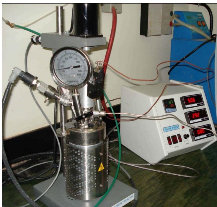
Figura 8: Reator Parr 4843 utilizado nas reações de polimerização.
