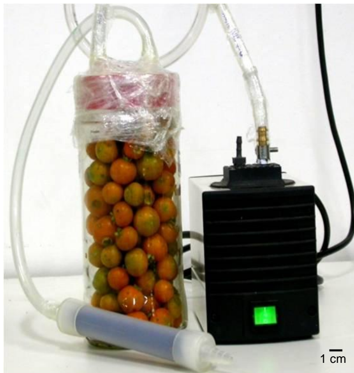
FIGURA 3. Sistema headspace : extração de voláteis de guabiropa.
