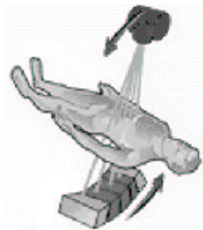
FIGURA 2.14 – Esquema de emissão e detecção de raio-X em tomografias.
