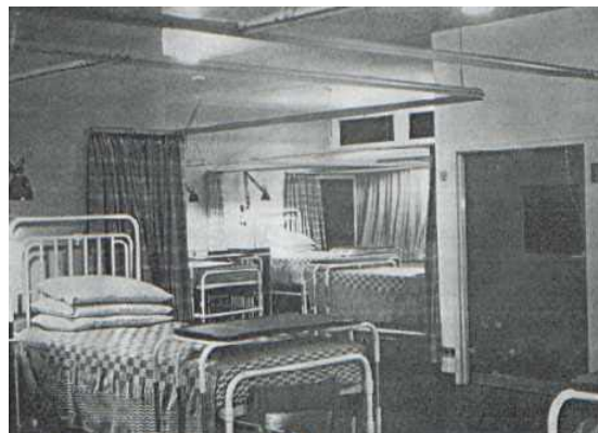
Figura 2.10: Enfermaria de hospital com iluminação indireta combinada à iluminação localizada junto aos leitos Fonte: HOPKINSON (1963, p. 128)
