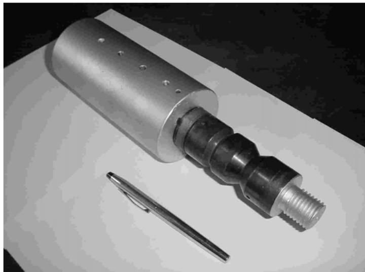
Figura 5.2. Vista dos cilindros externo e interno do amortecedor.
