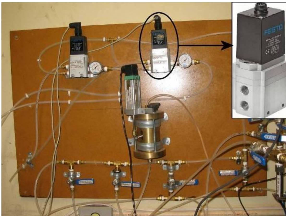
Figura 3.9: Vista da válvula proporcional utilizada na construção do equipamento triaxial.
