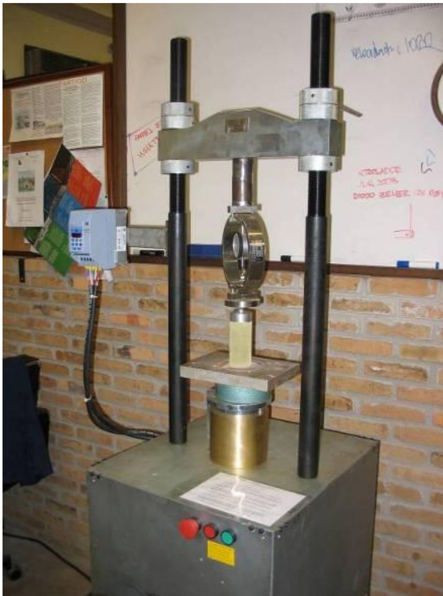
Figura 4.6: Prensa para ensaios de compressão simples.
