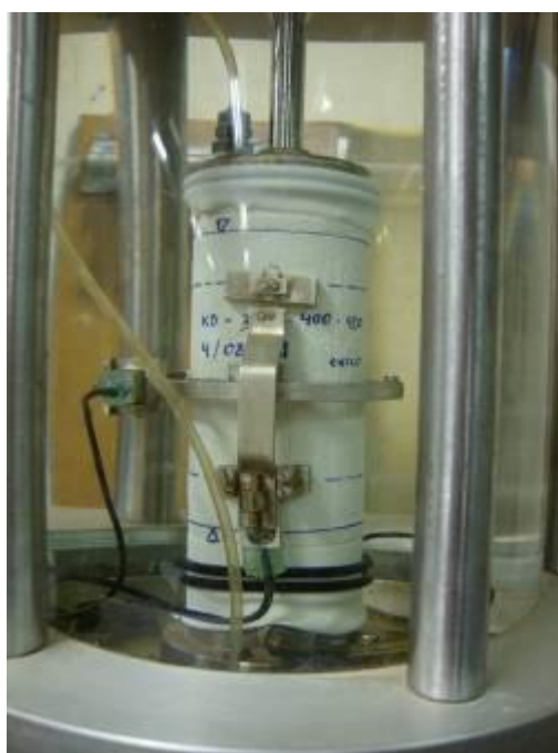
Figura 4.10: Ensaio triaxial durante a fase de cisalhamento.
