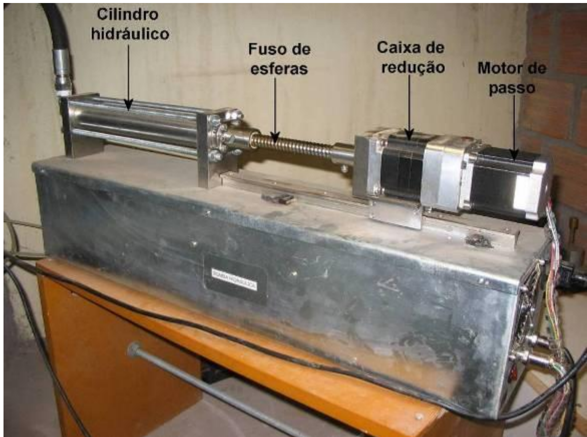
Figura 3.11: Visão geral da bomba hidráulica desenvolvida neste estudo.
