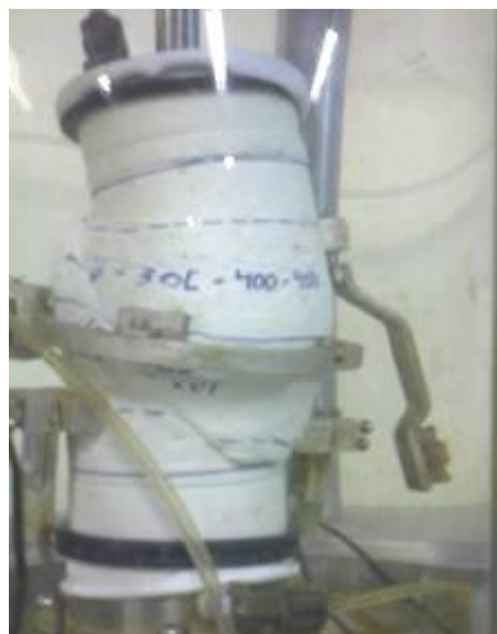
Figura 5.8: Identificação do plano de cisalhamento para amostras curadas sob tensão.
