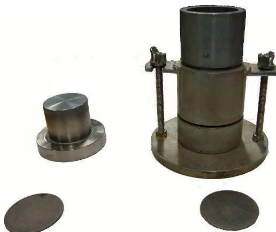
Figura 4.5: Molde e acessórios utilizados na preparação das amostras.
