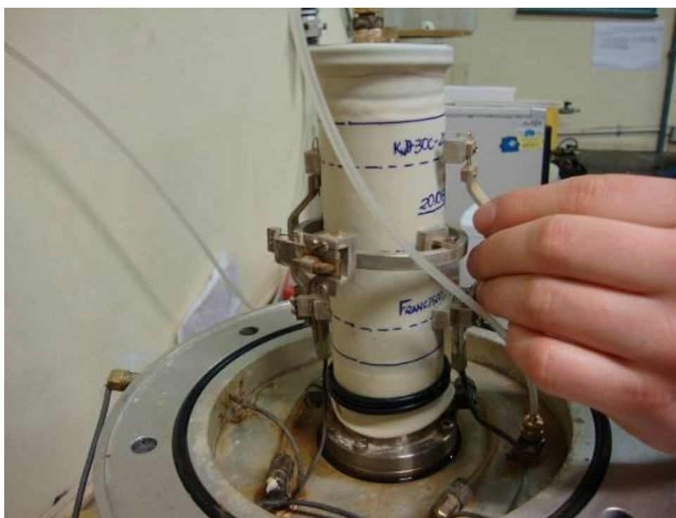
Figura 4.7: Posicionamento e fixação dos sensores locais de deformação.
