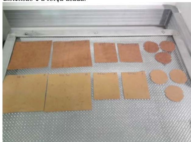
**Figura 3.** Corpos-de-prova para os testes de resistência à passagem de água de Maeser, Bally e distensão da flor-Lastômetro respectivamente.
