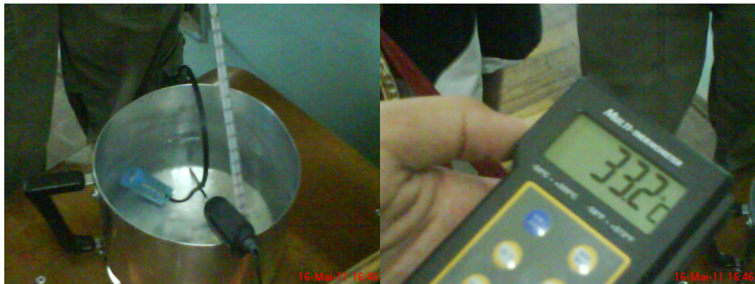
Figura 14: Foto do lado esquerdo mostra a medição da temperatura da água e a foto do lado direito mostra o indicador digital
