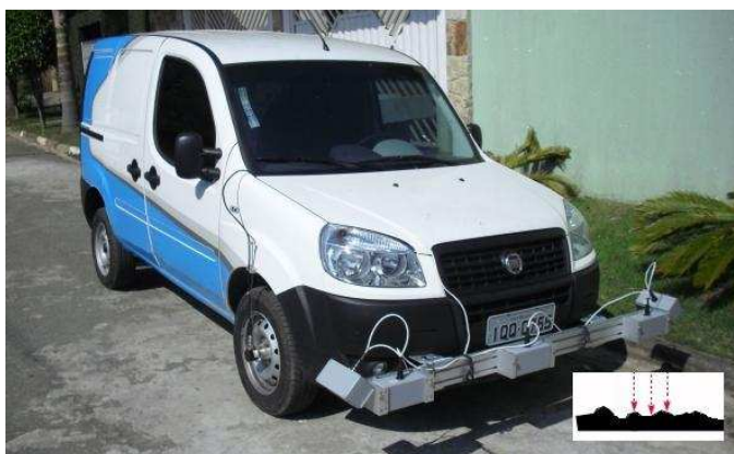
Figura 4.2.1 Perfilômetro acoplado ao veículo em detalhe o Laser de medição de y (mm)
