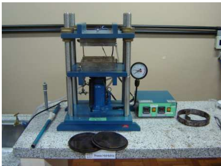
Figura 8: Prensa mecânica utilizada para a moldagem por compressão de placas para a estampagem de corpos de prova.
