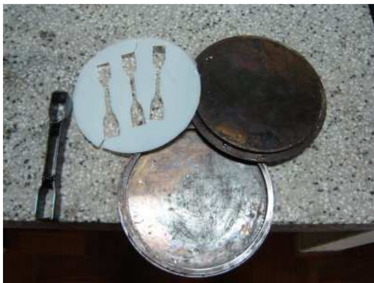
Figura 9: Placa circular com espessura de 4 mm, molde e gabarito para estampagem de corpos de prova.
