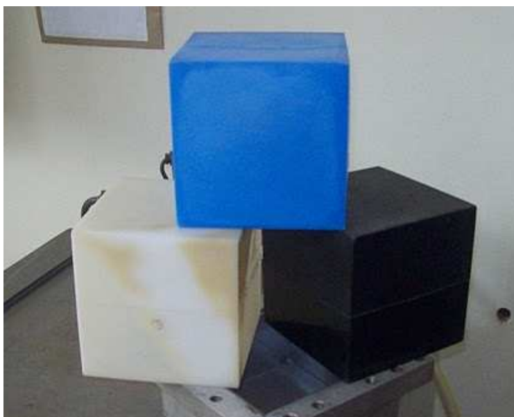
Figura 11: Exemplos de peças de geometria cúbica produzidas com o conjunto molde e máquina utilizados na realização dos ensaios de moldagem.
