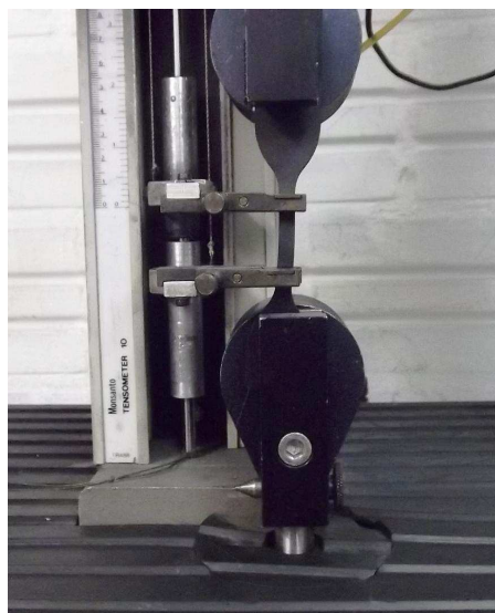
Figura 15. Ensaio de resistência à tração para um composto vulcanizado de borracha
