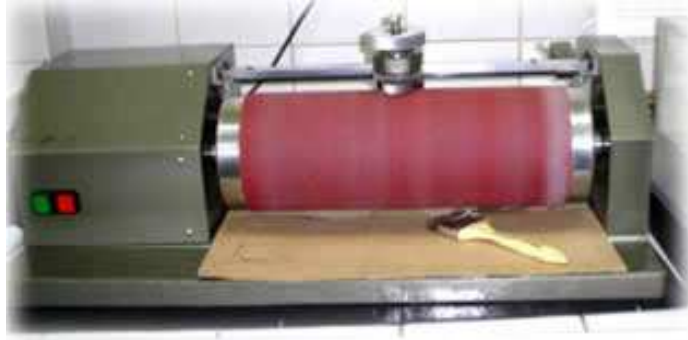
Figura 19. Lixa presa a um tambor rotativo em um aparato de ensaio de abrasão.
