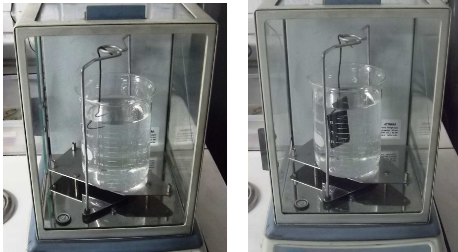
Figura 13. Procedimento experimental para a determinação da densidade absoluta
