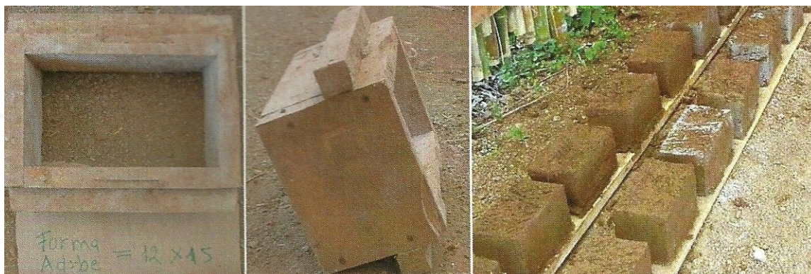
Figura 43: fôrmas de madeira e tijolos de adobe resultantes, aplicados na construção de cabanas, no Integria. Fonte: Daudt (2006).
