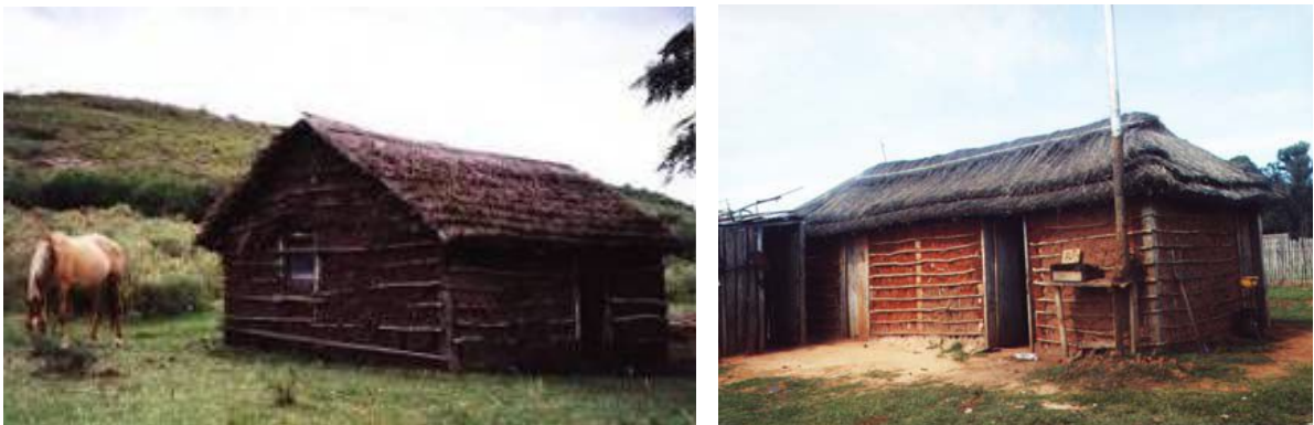
Figura 31: técnica de pau-a-pique, utilizada em habitações rurais no Uruguai, em Tacuarembó e Rivera, respectivamente. Fonte: Etchebarne et. al. (2006).
