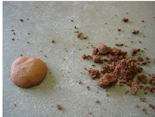
Figura 12: teste de queda da bola - à esquerda, terra argilosa; à direita, arenosa. Fonte: NEVES et. al. (2005)
