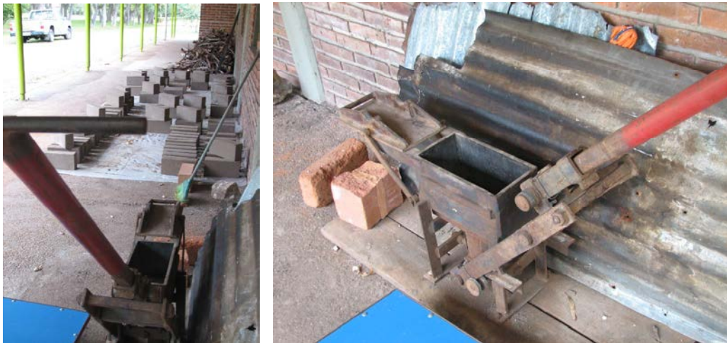
Figura 27: prensa CINVA-RAM, adotada para a fabricação de BTC, ou solo-cimento, nas obras apoiadas pela UDELAR.
