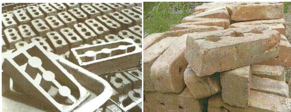
Figura 42: fôrmas metálicas e tijolos resultantes, com propriedades termo-acústicas, utilizados na cúpula do Integria. Fonte: Minke (2008) e Integria.
