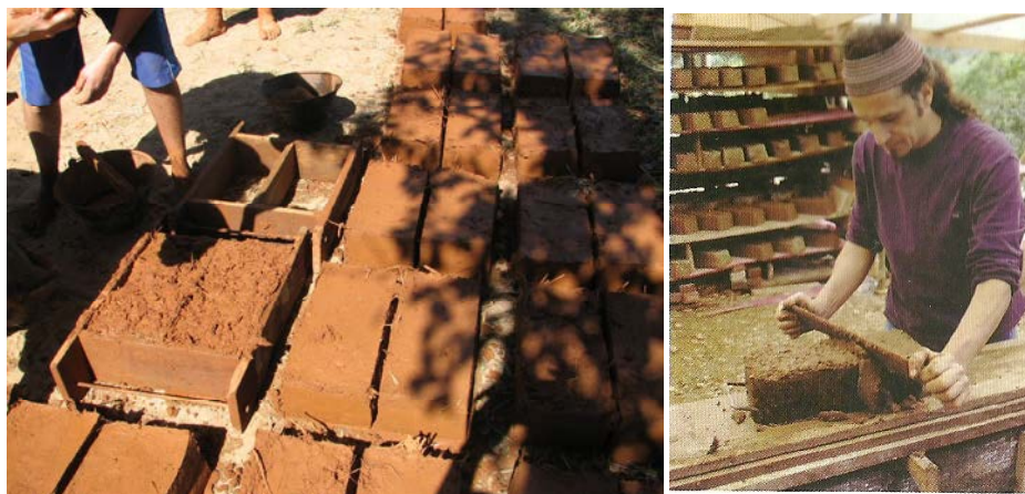
(a) (b) Figura 50: (a) moldagem de tijolos de adobe; (b) regularização da superfície do tijolo, com régua. Fonte: 50b - Minke (2008).
