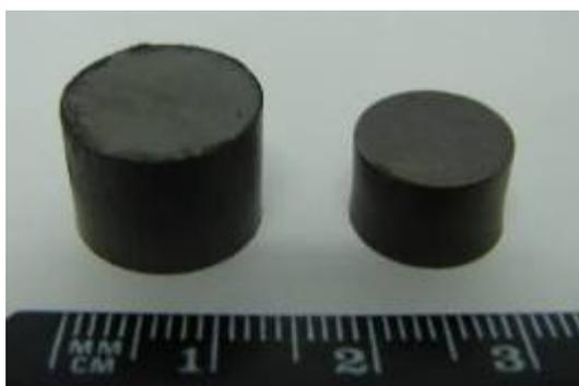
Figura 71: Compactada (esq.) e a sinterizada (dir.) WC-6Co
