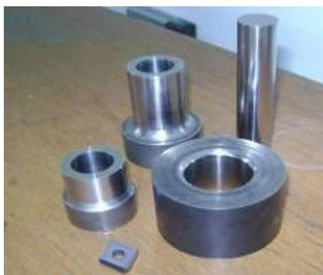
Figura 44: Ferramental de compactação toroidal
