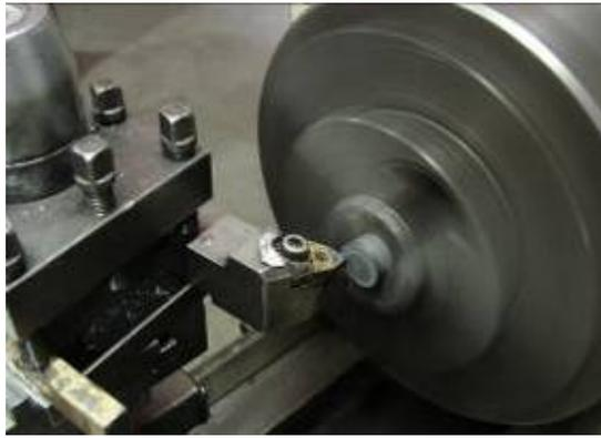
Figura 65: Faceamento da amostra pré-sinterizada.
