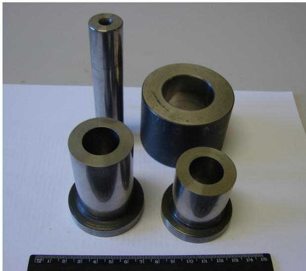
Figura 105: Ferramental de compactação do anel.
