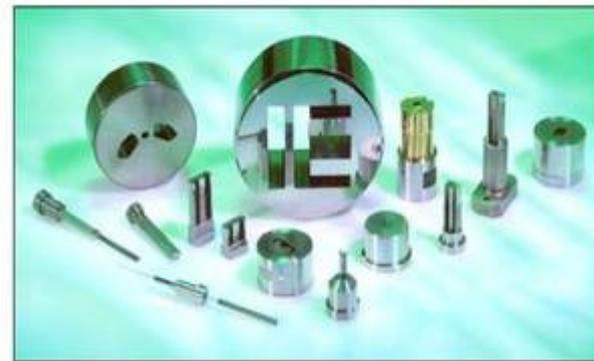
Figura 25: Ferramentas de compactação de pós (89).
