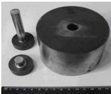
Figura 43: Ferramental de compactação cilíndrica
