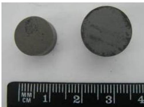
Figura 70: Sinterizada (esq.) e compactada (dir.) WC-6Co.
