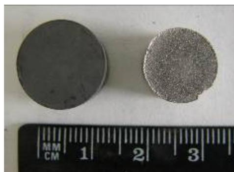
Figura 69: Compactada (esq.) e sinterizada (dir.) WC-6Co
