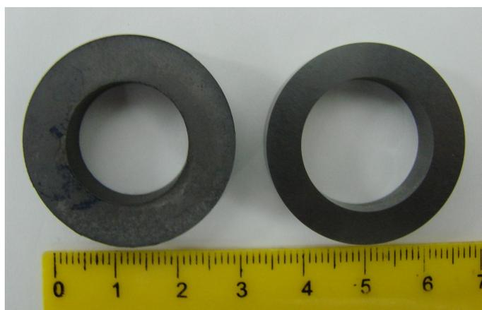
Figura 107: Anel bruto de sinterização e anel retificado.
