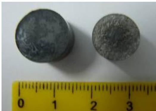
Figura 72: Compactada (esq.) e sinterizada (dir.) WC-6Co.
