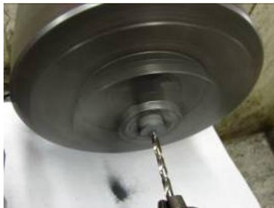
Figura 67: Furação da amostra pré-sinterizada
