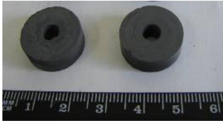
Figura 66: Amostras pré-sinterizadas e usinadas.
