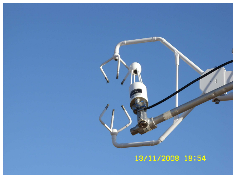
Figura 10. Sistema de covariância de vórtices ( eddy covariance ): anemômetro sônico e analisador de gás de caminho aberto.
