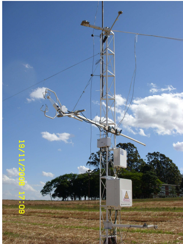
Figura 9. Torre micrometeorológica utilizada nas medidas na cultura de soja na CCGL.
