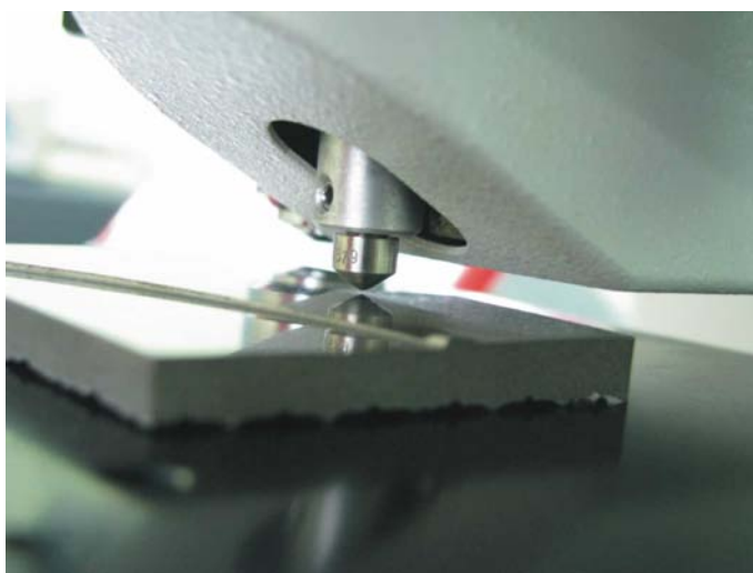
Figura 03: Teste de dureza feito com Microdurômetro.
