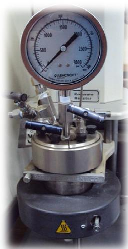
**Figura 37. Reator Parr com volume interno de 50 mL.**
