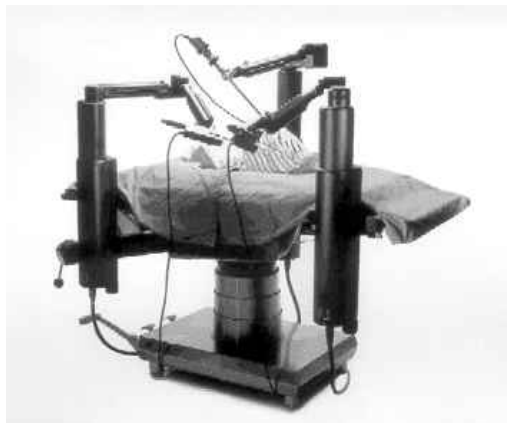
Figure 11 - Sistema Zeus de cirurgia robótica para procedimentos de videolaparoscopia ( Computer Motion , Santa Barbara, CA, U.S.A.).
