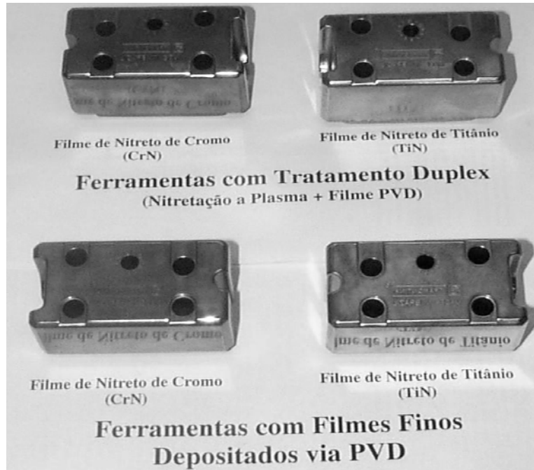
Fig 43 – Caracterização dos componentes tratados superficialmente para teste em regime industrial.
