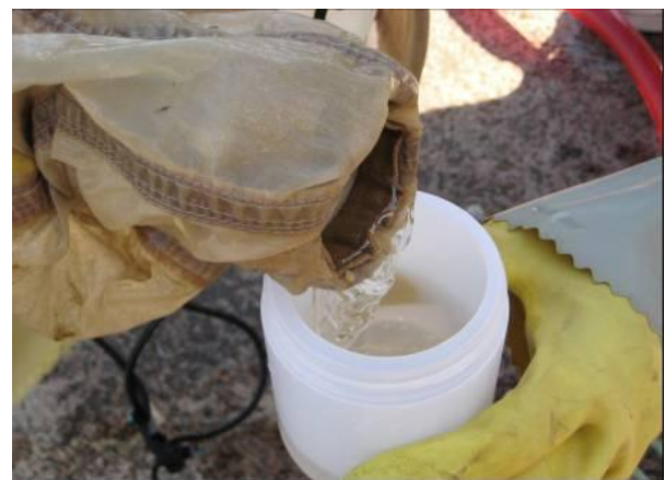
Figura 4. Retirada da amostra da rede de plâncton e acondicionamento.
