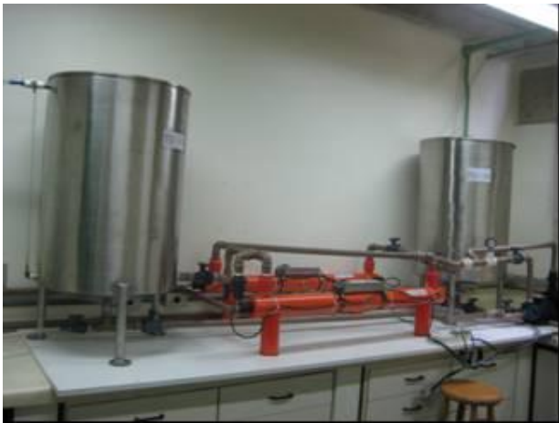
Figura 6. Unidade piloto de tratamento com radiação ultravioleta.
