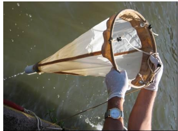
Figura 3. Rede de plâncton vista geral com malha de 30 \mu\text{m} .
