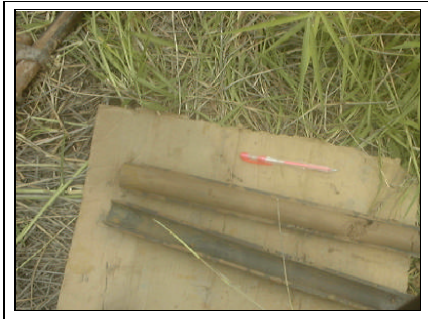
Figura 3-3: O amostrador contendo a amostra de 0,50m de solo.
