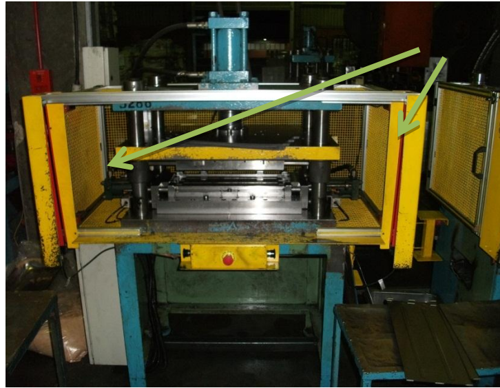
Figura 3: Prensa, da empresa, com proteções fixas das partes móveis.
