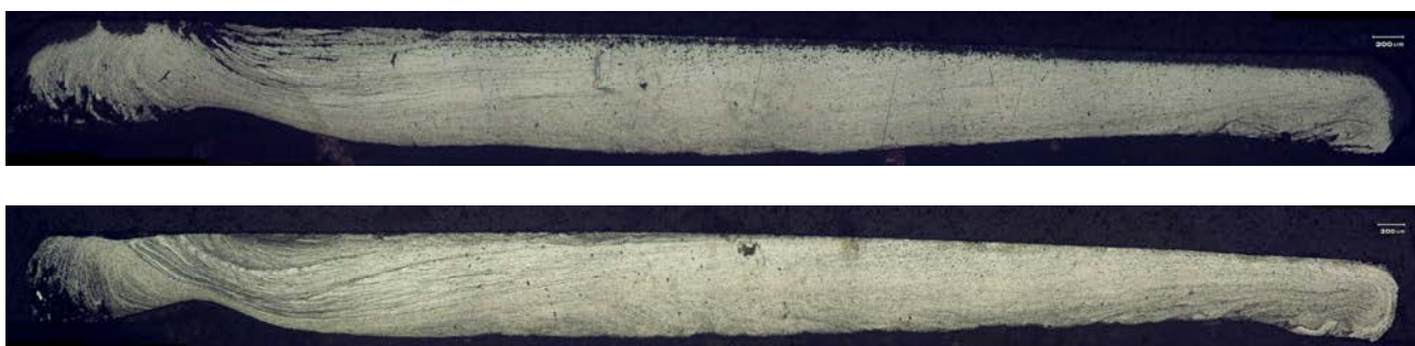
Figura 4.41 Micrografias dos depósitos realizados nas condições 10 e 12 mostrando o fluxo plástico do material do depósito.
