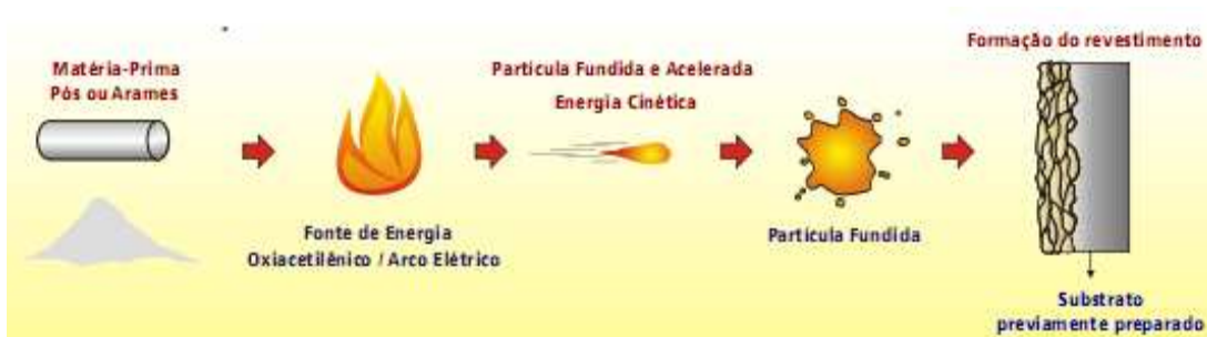
Figura 2.49 Desenho esquemático do processo por aspersão térmica (CASTOLIN EUTECTIC 2010).
