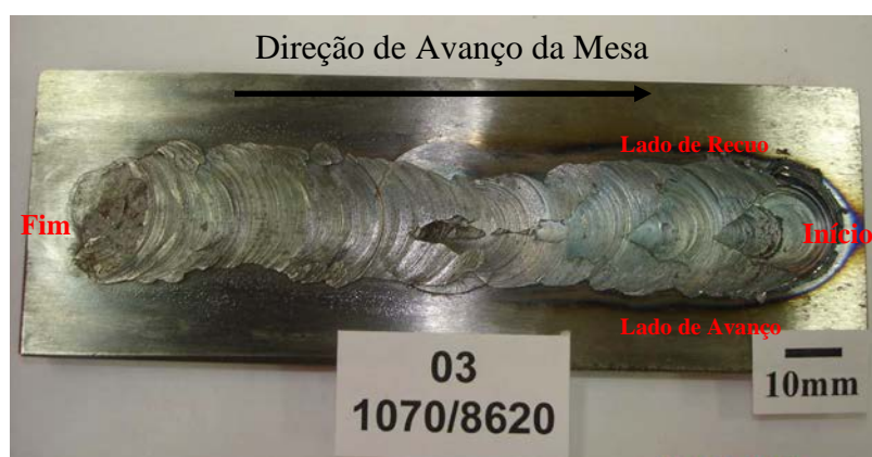
Figura 4.4 Macrografia do depósito realizado com o pino consumível SAE 8620 na condição 3 ( F=13,7 kN e V_a=8,5 mm/s), que apresentou-se de forma irregular.
