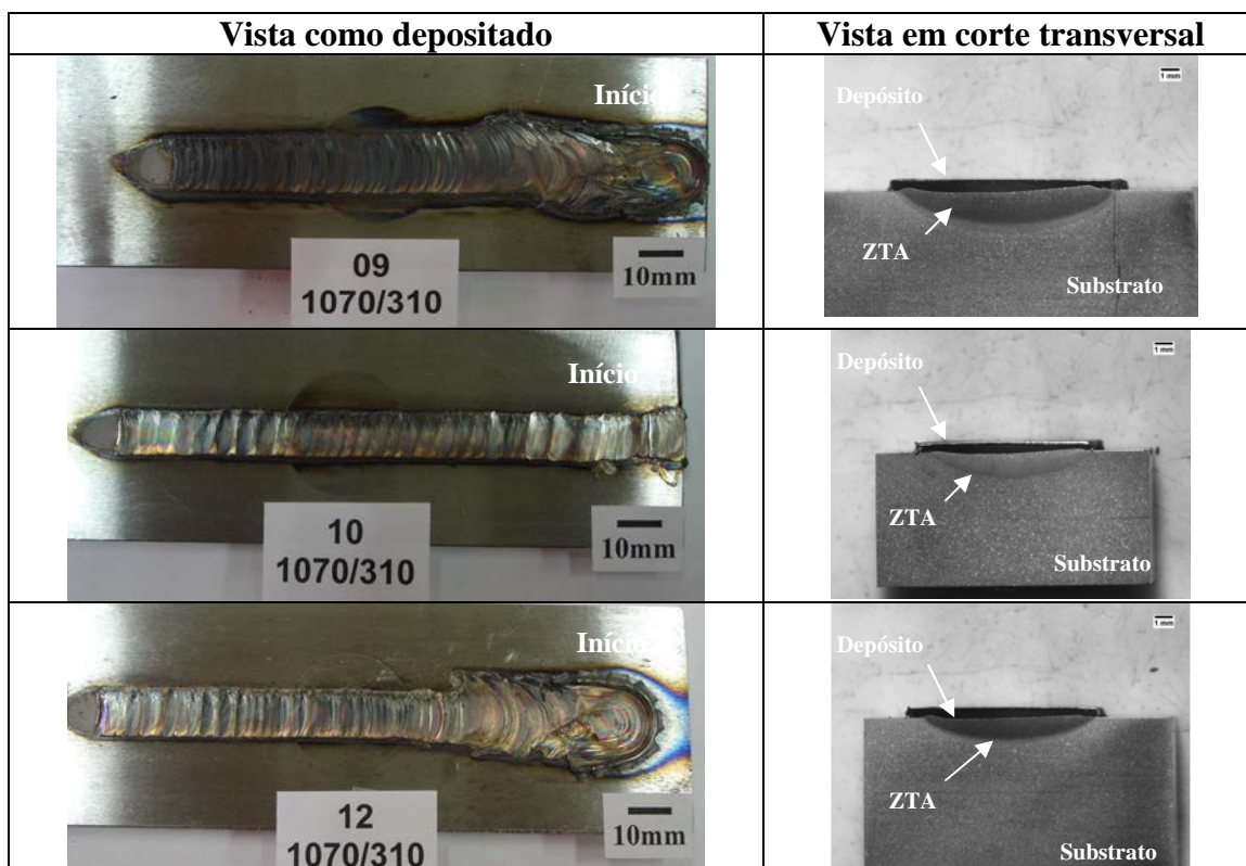
Figura 4.3 Macrografias dos depósitos realizados com o pino consumível AISI 310.
