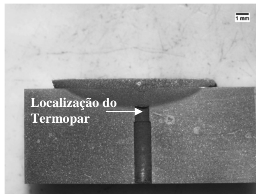
Figura 3.10 Macrografia em seção transversal mostrando a localização do termopar.
